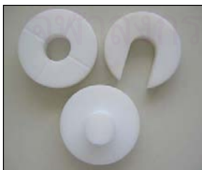
ภาพที่ 12 แสดงแบบหล่อเทฟลอนที่ใช้เตรียมชิ้นทดสอบจากวัสดุเรซินคอมโพสิต
