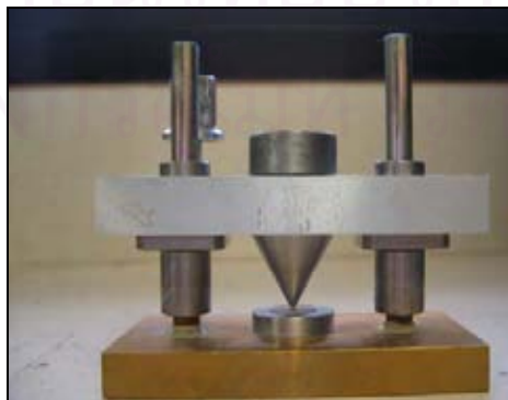
ภาพที่ 13 แสดงชุดกดแบบลูกเหล็กกลมหนึ่งลูก กดบนส่วนรองรับที่เป็นลูกเหล็กกลมสามลูก
