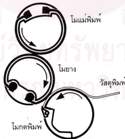
รูปที่ 2.3 ลักษณะโมของเครื่องพิมพ์ออฟเซตป้อนแผ่น
