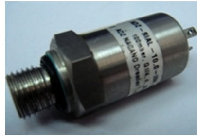
V. อุปกรณ์ตรวจวัดแรงดัน
