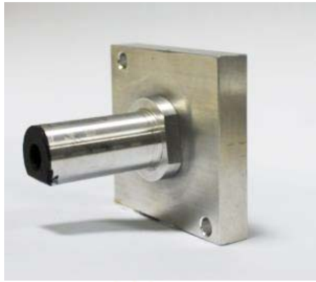
รูปที่ 3.6 คอลลิเมเตอร์ของหลอดรังสีเอกซ์หลังกลึงขึ้นรูปแล้ว
