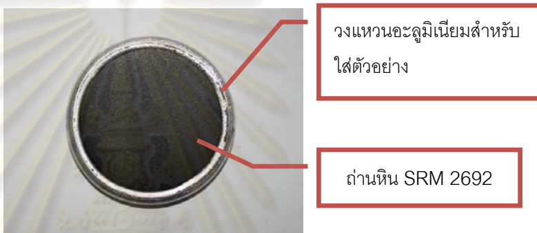
รูปที่ 3.20 ตัวอย่างถ่านหิน SRM 2692 อัดแผ่นกลม
