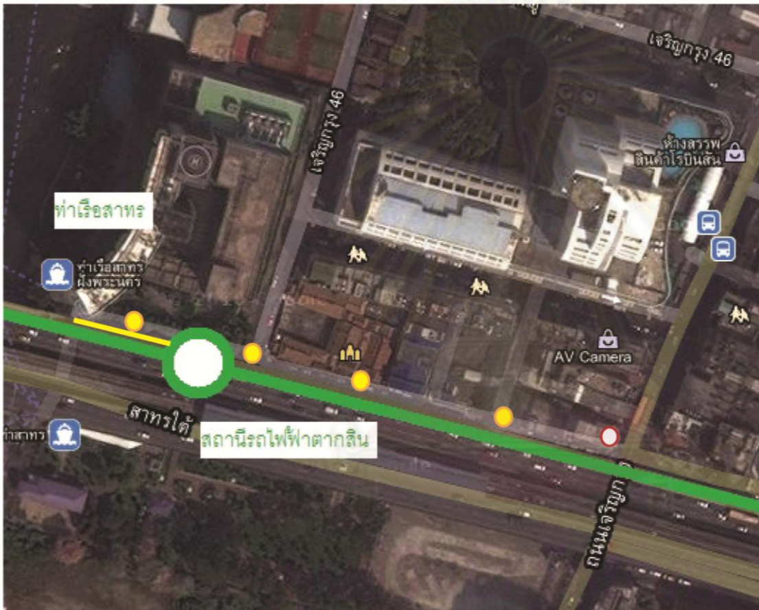
รูปที่ 6.8 แสดงแนวทางการพัฒนาการเชื่อมต่อด้วยเรือด่วนเจ้าพระยาเชื่อมต่อโครงข่ายระบบรางบริเวณท่าเรือสาทร
