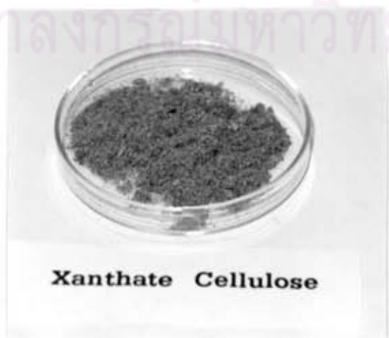
รูปที่ 4.3 สารเซลลูโลสแลกเปลี่ยนไอออนชนิดโครอสลิ่ง-แซนเทตที่มี Effective size 0.18-0.212 มม.
