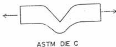
รูปที่ 3.7 ลักษณะชิ้นทดสอบความต้านทานต่อการฉีกขาด
