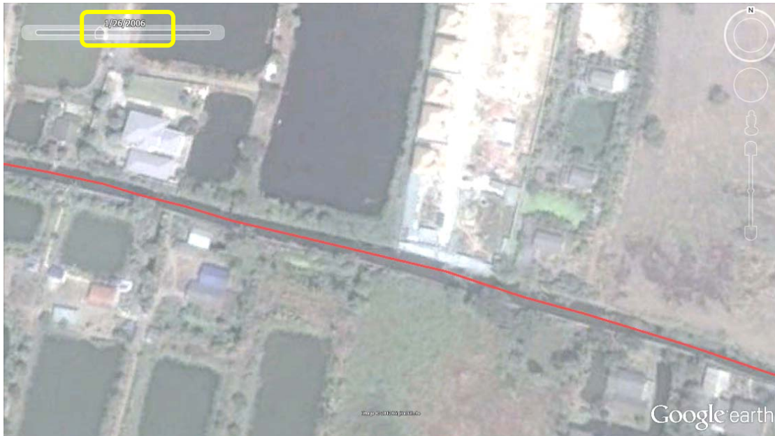
รูปที่ 3.26 การดิจิทัลเส้นลำน้ำจากภาพถ่ายดาวเทียมในปีที่ใกล้เคียงกับข้อมูลไลดาร์มากที่สุด จากซอฟต์แวร์ Google Earth
