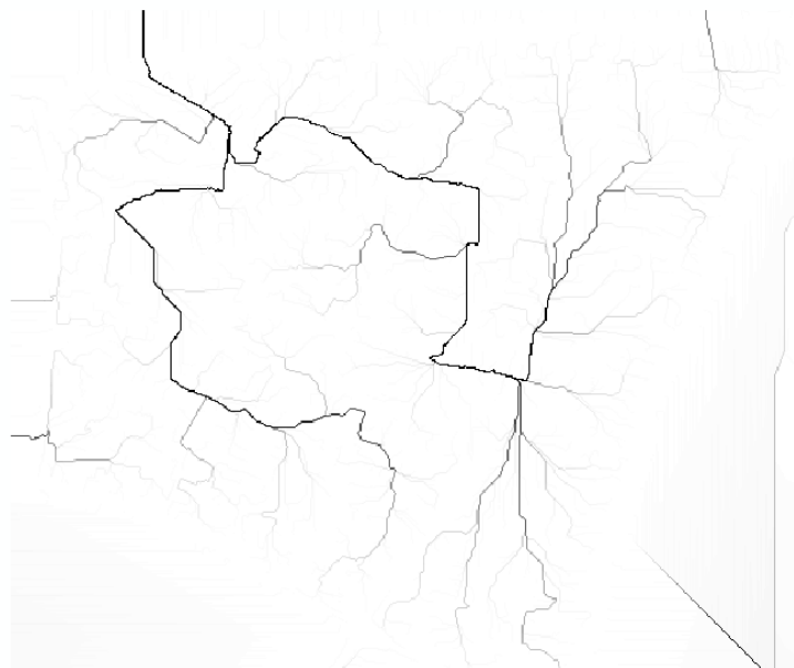
รูปที่ 3.16 แสดงผลการประมวลผล Flow accumulation ด้วยซอฟต์แวร์ ArcGIS 9.3
