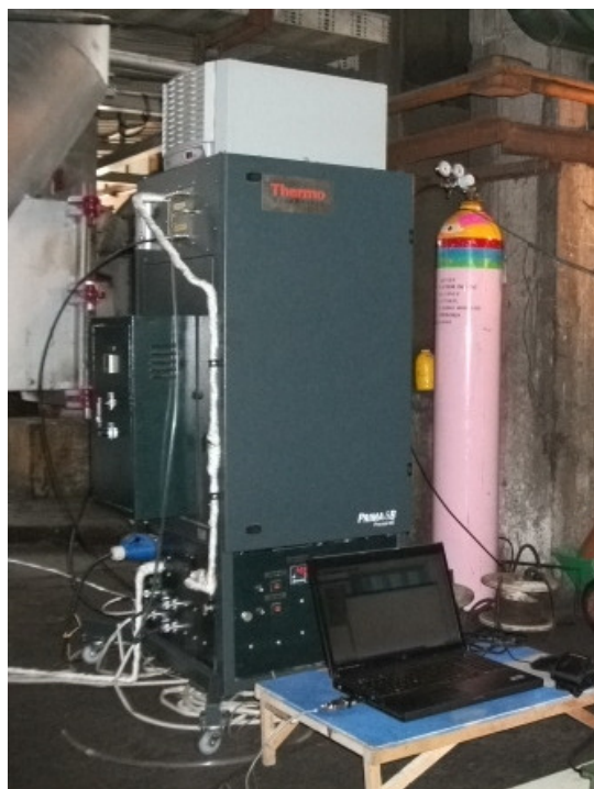
ภาพที่ 3.14 เครื่อง Mass Spectrometer รุ่น Prima 8B
