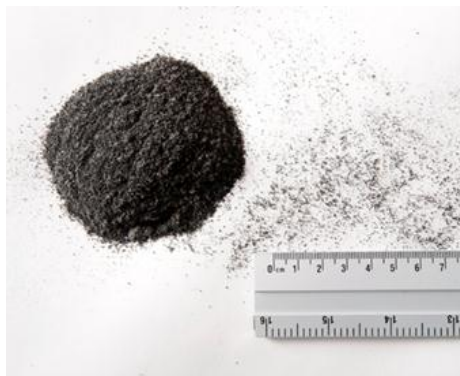
ภาพที่ 3.7 เม็ดยางที่ทำมาจากเศษยางรถยนต์ที่ใช้แล้วบดละเอียด
