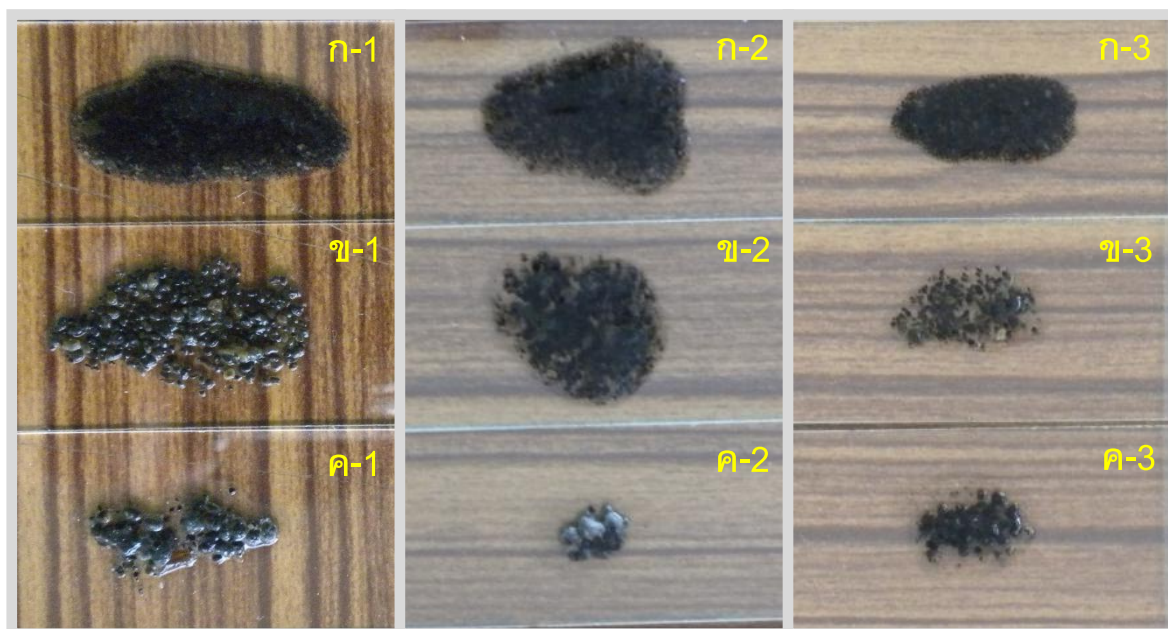
ภาพที่ 4.16 ลักษณะเม็ดตะกอนจากตำแหน่งต่างๆ ของถึงปฏิกรณ์ที่ 1 เปรียบเทียบระหว่างการเดินระบบที่อัตราภาวะบรรจุทุกสารอินทรีย์ 30 15 และ 2 กก.ซีโอดี/ลบ.ม.-วัน เมื่อนำเม็ดตะกอนจากชั้นเบด (ก) ช่วงบน (ข) ช่วงกลาง และ (ค) ช่วงล่าง มาส่องดูด้วยกล้องจุลทรรศน์ที่กำลังขยาย 40 เท่า
