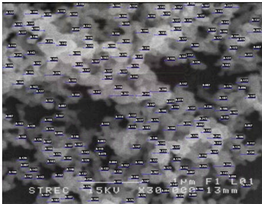
รูปที่ ค.14 แสดงการวัดขนาดอนุภาคจากภาพ SEM อัตราส่วน 1:1 อุณหภูมิ 140°C เวลา 60 นาที
