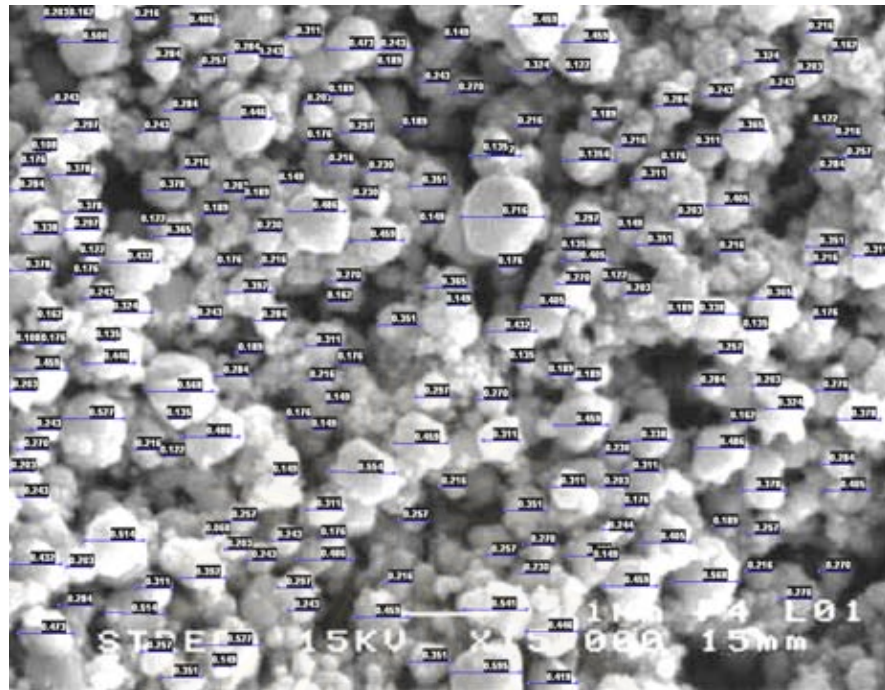
รูปที่ ค.19 แสดงการวัดขนาดอนุภาคจากภาพ SEM อัตราส่วน 10:1 อุณหภูมิ 30°C เวลา 120 นาที
