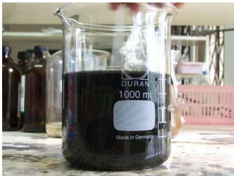
รูปที่ 4.8 แสดงการผลิตผงเงินจากการทำปฏิกิริยาสารละลายไซเดียมไฮดรอกไซด์ในกลีเซอรอล ในอัตราส่วน 1:1 โมล ที่อุณหภูมิ 30 °C เวลา 120 นาที
