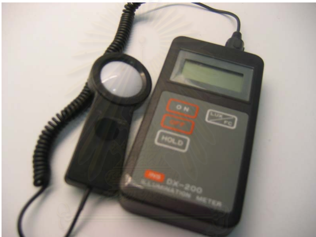
ภาพที่ 3.1 แสดงเครื่องมือทดลองวัดความส่องสว่าง (Illumination Meter)
