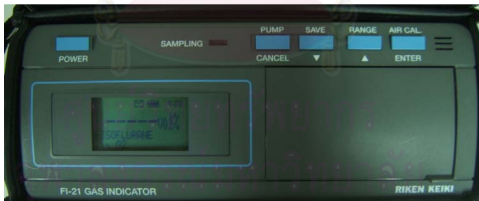
ภาพที่14 Anesthetic gas monitor, model FI-21 สำหรับวิเคราะห์ค่าความเข้มข้นของไอโซฟลูเรนในลมหายใจของสุนัข
