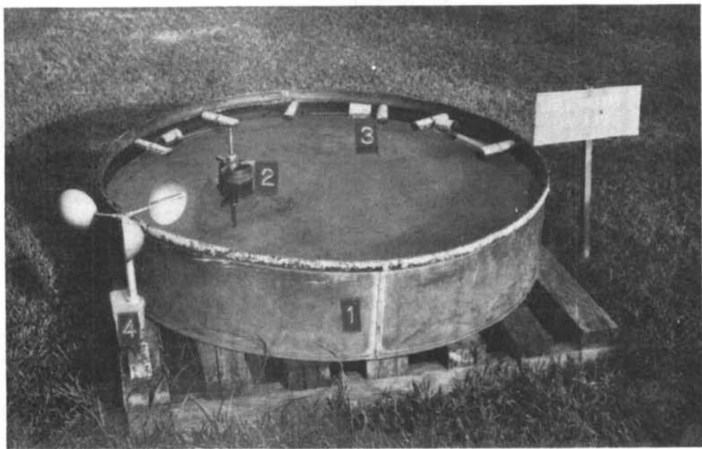
รูปที่ ๒.๑ ภาพแสดงถาดน้ำระเหยแบบอเมริกัน ชั้นเอ ประกอบด้วย : ๑. ถาดน้ำระเหย ๒. บ่อน้ำนิ่งและชอว์คัมกับน้ำ ๓. เทอร์โมมิเตอร์ลอยน้ำ ๔. เครื่องวัดความเร็วลม
