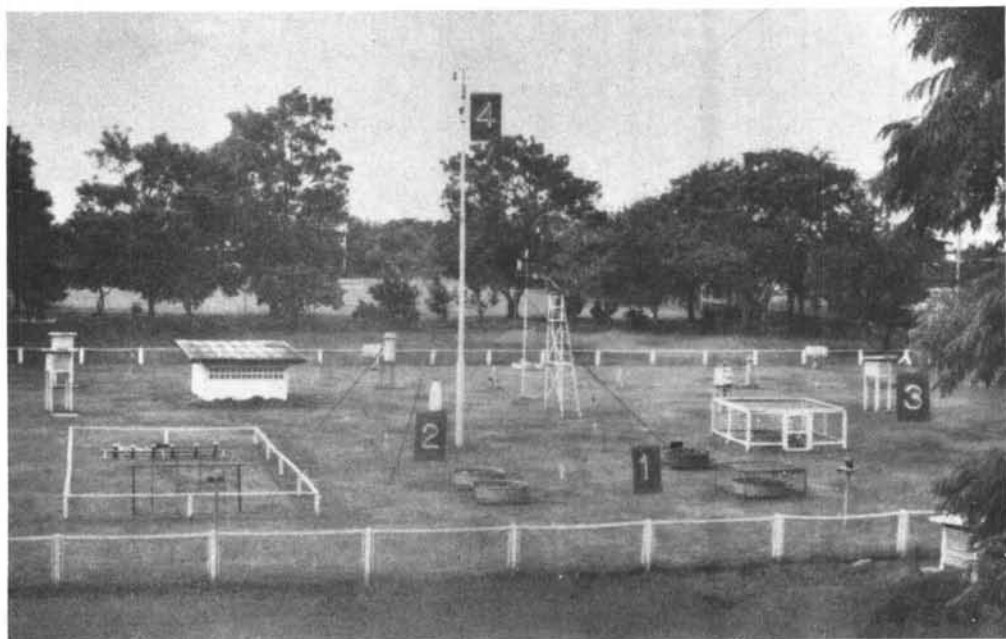
รูปที่ ๒.๒ ภาพแสดงสถานที่ติดตั้งถาดน้ำระเหยที่สวนราชการกรมอุตุนิยมวิทยา บางนา กรุงเทพฯ โดยมีเครื่องมือตรวจอากาศติดตั้งไว้ เช่น : ๑. ถาดน้ำระเหย ๒. เครื่องมือวัดฝน ๓. เรือนเทอร์โมมิเตอร์ ๔. เครื่องวัดความเร็วและทิศทางลม
