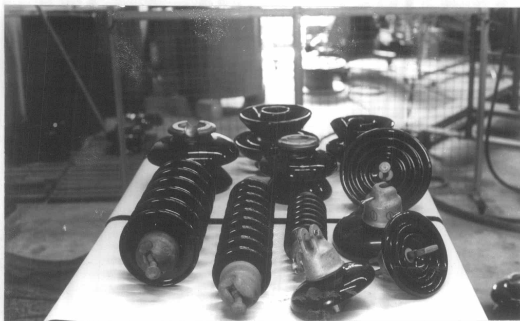
รูปที่ ๕.๑๑ แสดงตัวอย่างลูกถ้วยฉนวนไฟฟ้าแต่ละชนิดที่ใช้ในการทดสอบ
