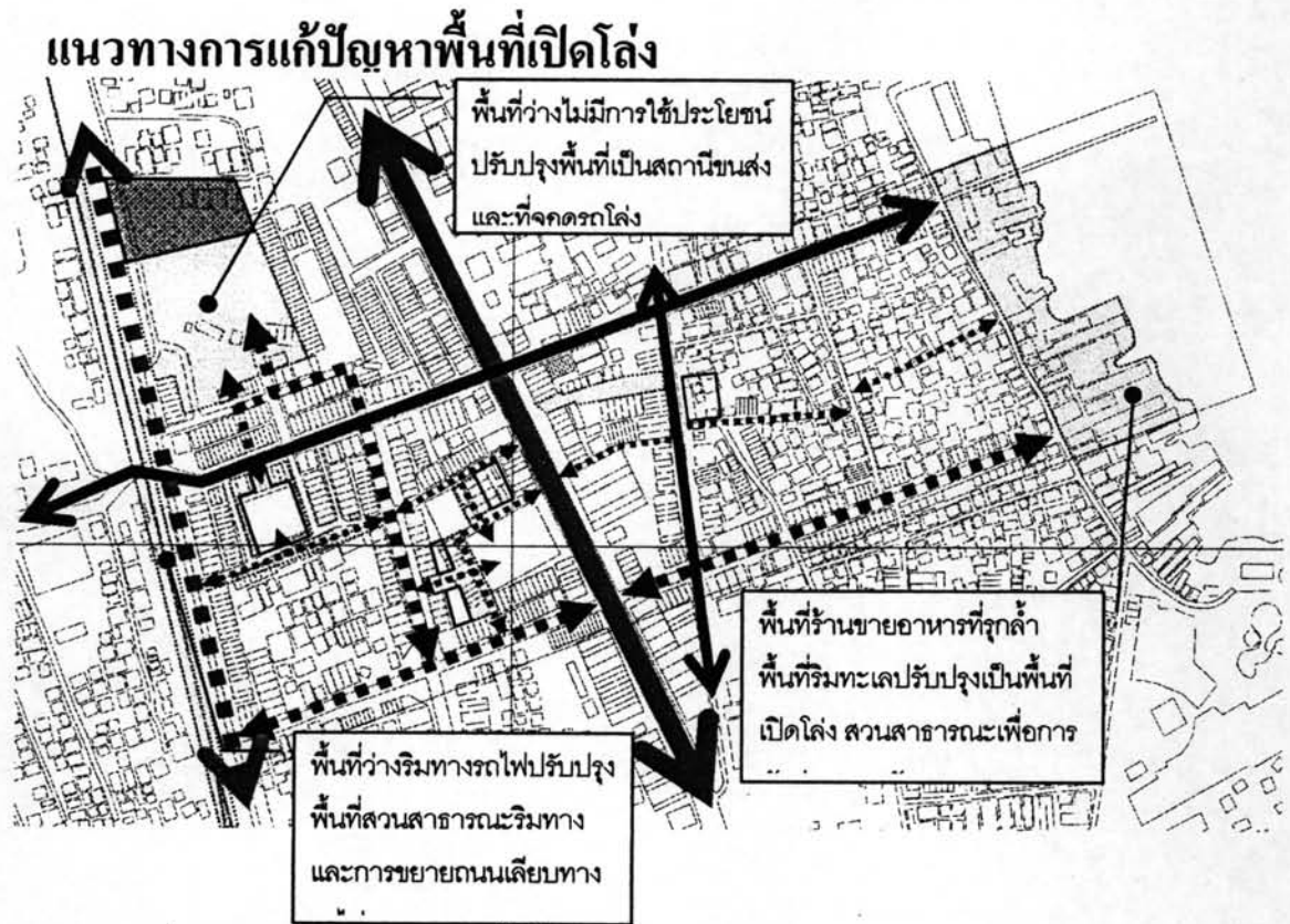
ภาพที่ 4.14 แนวทางการแก้ปัญหาพื้นที่เปิดโล่ง
