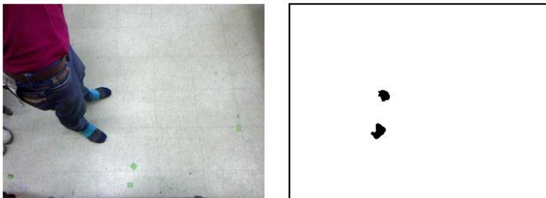
รูปที่ 5.5 (ซ้าย) ภาพสีที่ได้จาก Kinect (ขวา) ภาพที่ได้จากการคัดกรองเฉพาะสีของแถบผ้า
