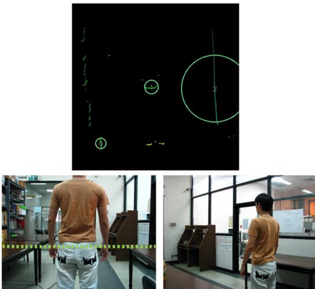
รูปที่ 4.10 (บน) แสดงการจัดกลุ่มข้อมูลจาก LRF พร้อมระบุหมายเลขและวงล้อมกลุ่ม (ล่าง) สภาพแวดล้อมจริง เส้นประสีเขียวแสดงระดับที่ LRF วัดข้อมูล
