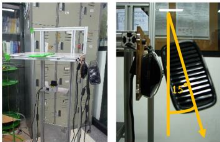
รูปที่ 5.1 แสดงการติดตั้ง Kinect กับหุ่นยนต์โดยทำมุม 15° กับเส้นแนวตั้งของพื้น
