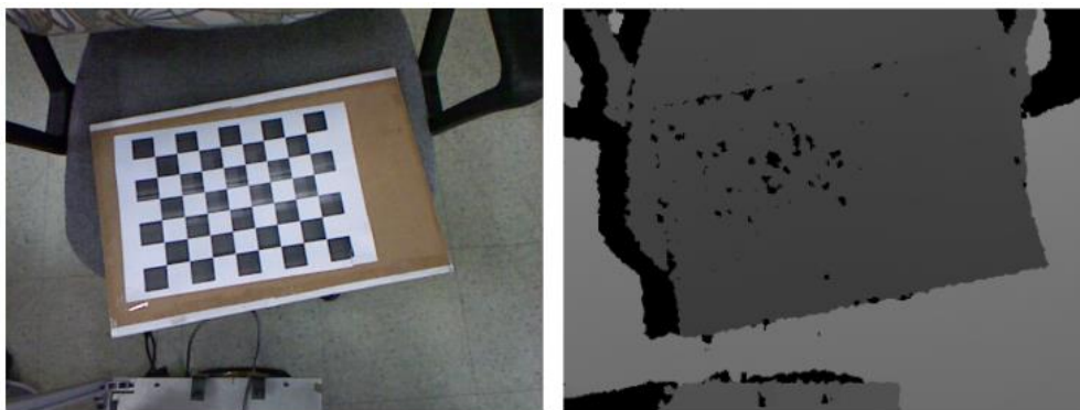
รูปที่ 4.5 แสดง RGB image และ Depth image ของตารางหมากรุกที่ได้จาก Kinect
