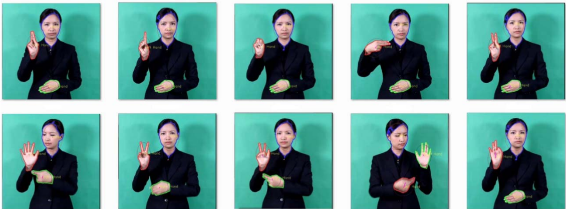
รูปที่ 4-3 ผลการติดตามการเคลื่อนไหวของมือจากวีดิทัศน์ในกรณีที่ไม่เกิดการบดบังกัน - การทดสอบกรณีมือซ้ายและมือขวาเกิดการบดบังกัน
