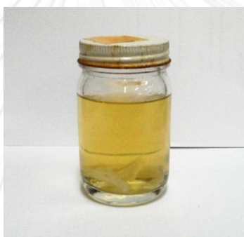
ภาพที่ 3.5 ผ้าฝ้ายกราฟต์ไกลซีดิลเมทาโคลเลต ในสารละลายโคโตซาน
