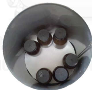
ภาพที่ 3.3 การนำผ้าฝ้ายในสารละลายไกลซิลเมทาโคลเลต ไปฉายรังสี
