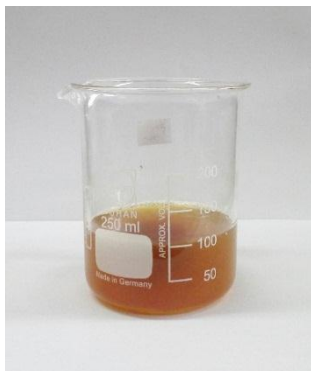
ภาพที่ 4.5 สารละลายโคโตซานน้ำหนักโมเลกุล 8386 ดอลตัน
