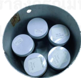
ภาพที่ 3.6 การนำผ้าฝ้ายกราฟต์ไกลซีดิลเมทาโคลเลต ในสารละลายโคโตซานไปฉายรังสีแกมมา
