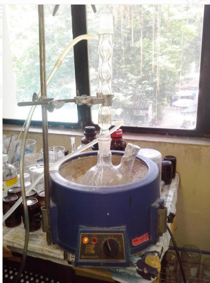
ภาพที่ 3.1 ระบบรีฟลักซ์กำจัดสารเจือปนในผ้าฝ้าย
