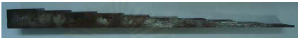
รูปที่ 3.8 เหล็กขั้นบันได
