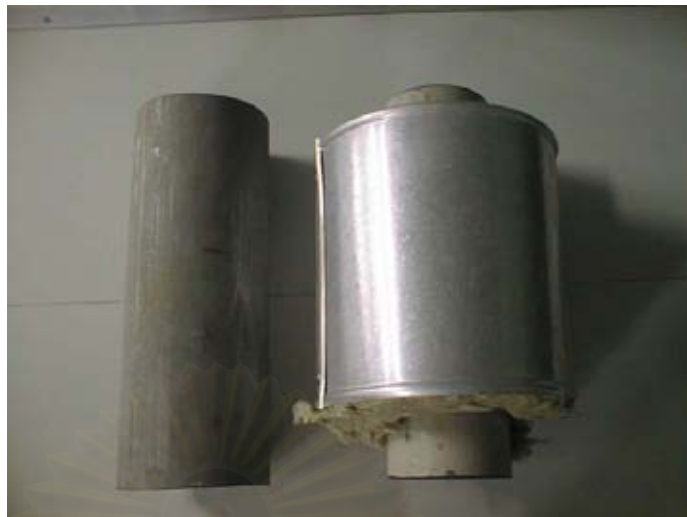
รูปที่ 3.10 ภาพตัวอย่างท่อหุ้มฉนวนความร้อน
