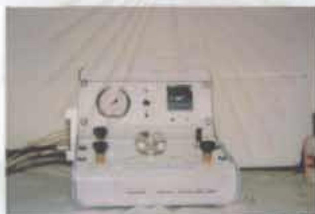
รูปที่ 8 เครื่องฟอกสีแห้งที่จุลวิภาค CPD7501
