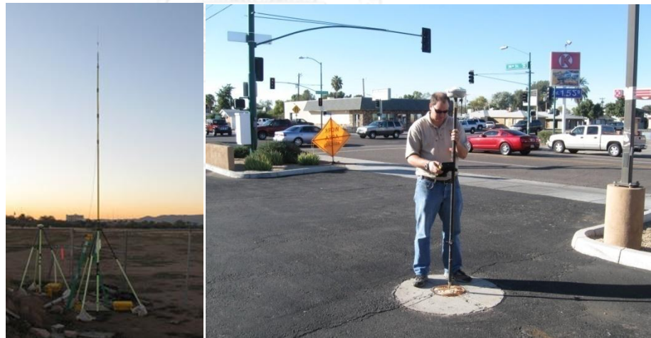
รูปที่ 2.14 แสดงการรังวัดแบบจลน์ในทันทีในสนาม (ซ้าย: สถานีฐาน, ขวา: สถานีผู้ใช้งาน)
