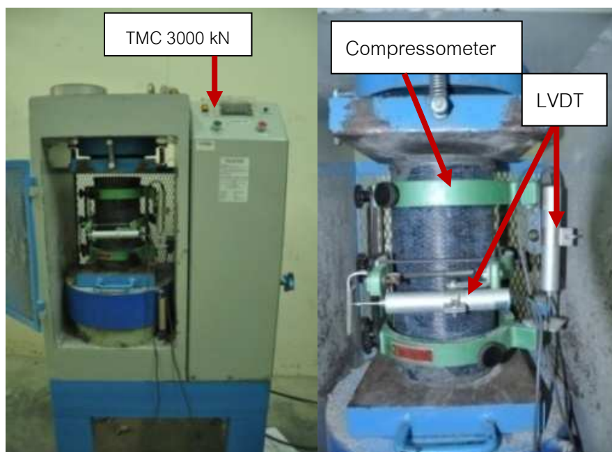
ภาพที่ 4.11 เครื่องทดสอบและการติดตั้ง LVDT
