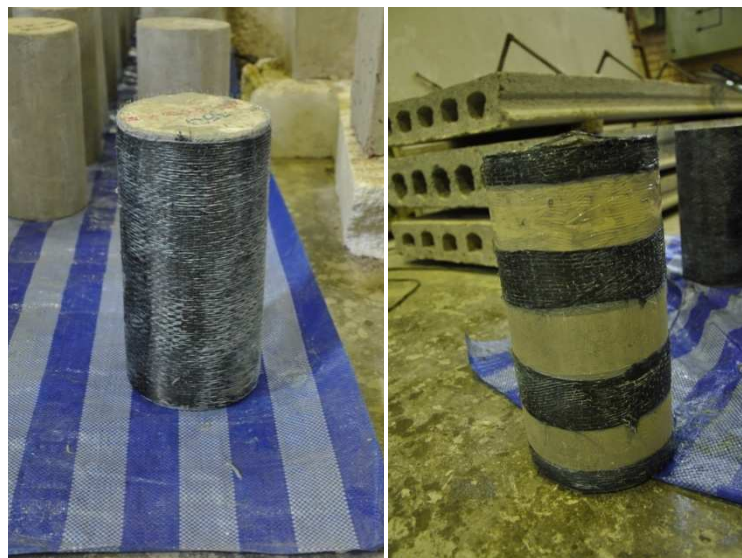
ภาพที่ 4.11 ชิ้นงานภายหลังการติดตั้งด้วยแผ่น CFRP
