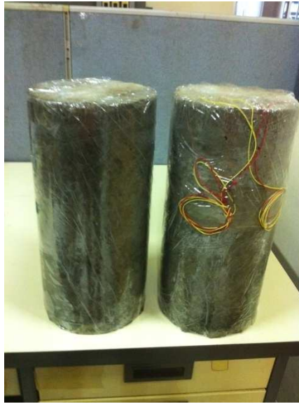
ภาพที่ 4.4 ลักษณะการบ่มชิ้นงานด้วยการพันแผ่นพลาสติก
