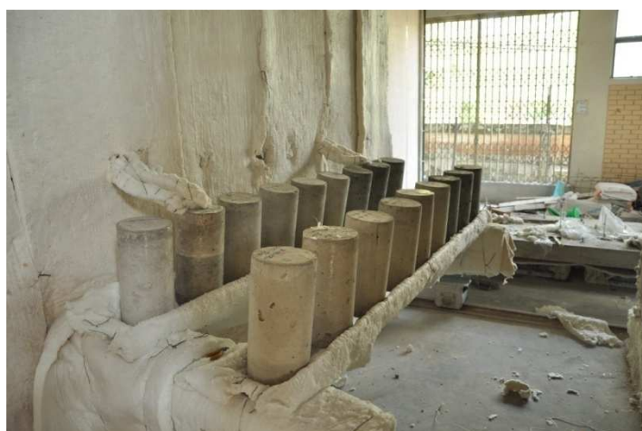
ภาพที่ 4.7 ลักษณะการติดตั้งชั้นวางชิ้นงานที่ออกแบบ
