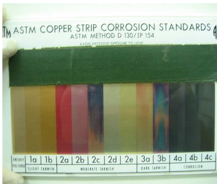
ภาพที่ 3.9 แผ่นเทียบสีการกัดกร่อน ตามมาตรฐาน ASTM D130/IP 154
