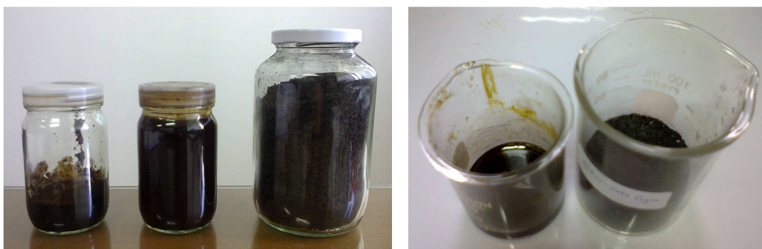
ภาพที่ 4.32 ผลิตภัณฑ์ที่ได้จากการไพโรไลซิสหญ้าคาของปฏิกรณ์สกรูเดี่ยว (ก) และปฏิกรณ์สกรูคู่ (ข)
