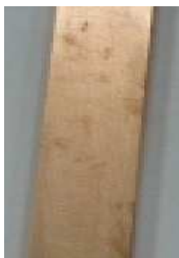
ภาพที่ 4.31 สภาพการกัดกร่อนของน้ำมันชีวภาพจากไพโรไลซิสของหญ้าคาด้วยปฏิกรณ์สกรูคู่
