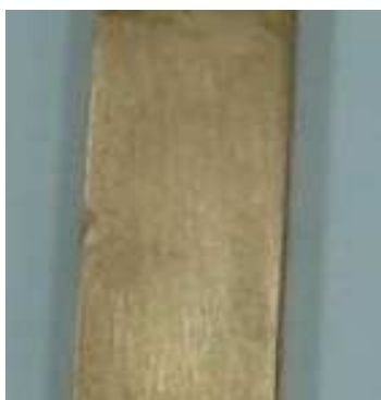
ภาพที่ 4.18 การกัดกร่อนของน้ำมันชีวภาพจากหญ้าคาที่ได้จากการไพโรไลซิสด้วยปฏิกรณ์สกรูเดี่ยว
