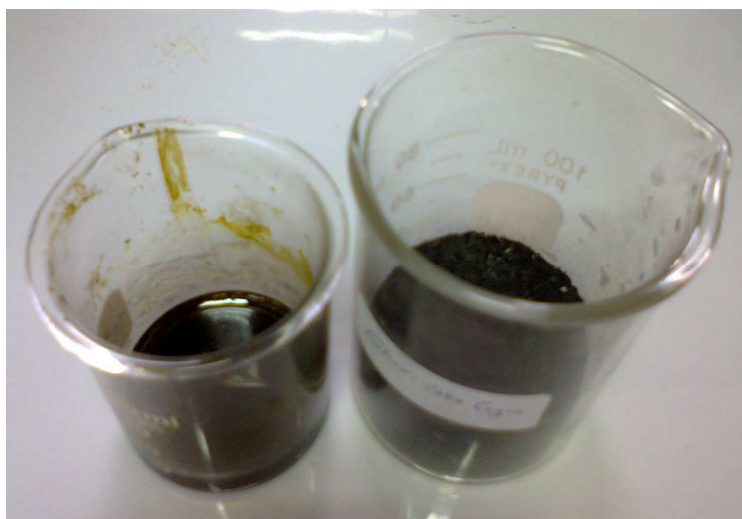
ภาพที่ 4.19 น้ำมันชีวภาพและถ่านชาร์ซึ่งเป็นผลิตภัณฑ์ที่ได้จากการไพโรไลซิสหญ้าคาด้วยปฏิกรณ์สกรูคู่
