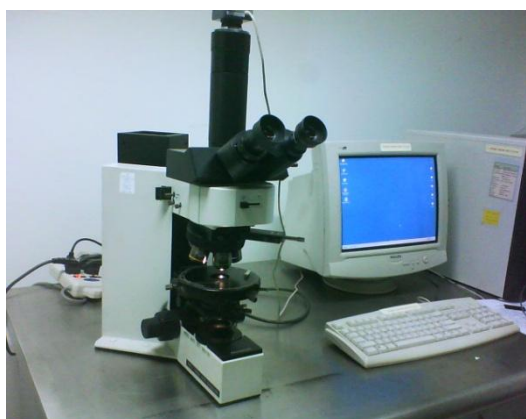
ภาพที่ 3.12 กล้อง Optical microscope ของบริษัท Olympus รุ่น BX60
