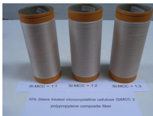
ภาพที่ 4.24 เส้นใยเชิงประกอบเซลลูโลสตัดแปรด้วยออร์แกโนซิลิโคน/พอลิโพรพิลีน (SiMCC/PP) ที่ความเข้มข้นของ SiMCC เท่ากับร้อยละ 10 โดยน้ำหนัก
