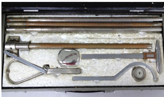
รูปที่ ก.7 ชุดเครื่องมือวัดขนาดสัดส่วนร่างกาย Anthropometer
