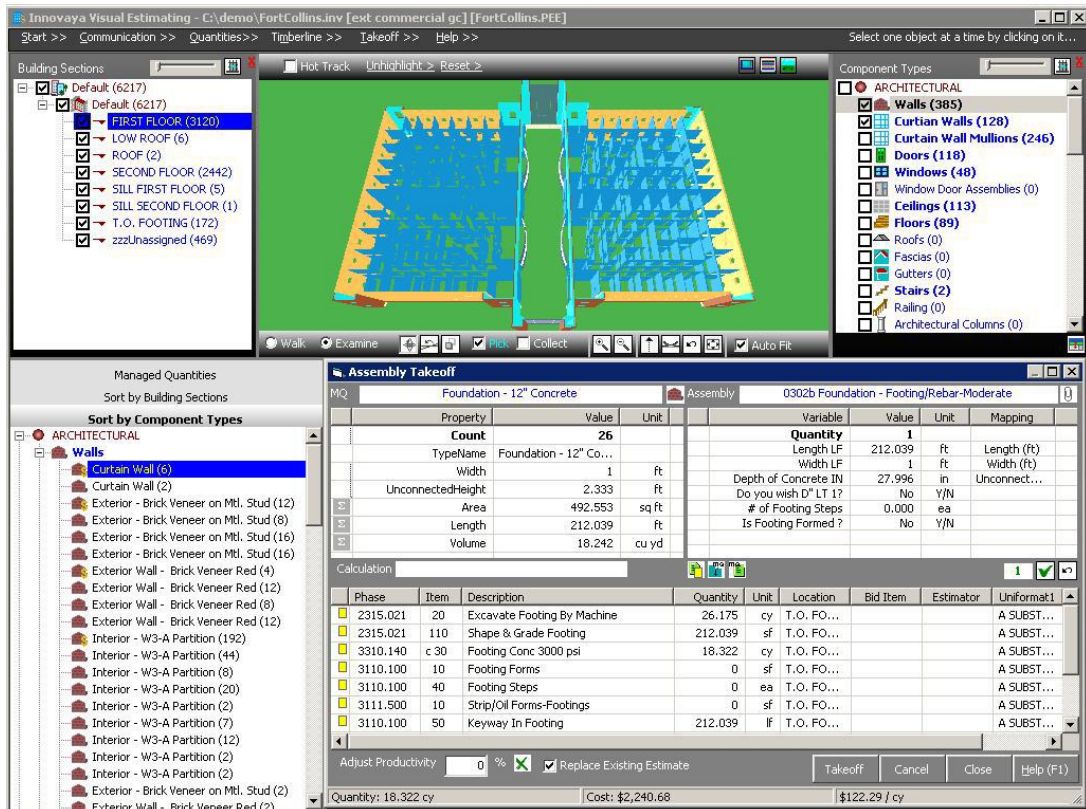
รูปที่ 2.9 แสดงตัวอย่างการคำนวณปริมาณงาน (Quantity take-off) โดยซอฟต์แวร์ Innovaya Visual Estimating (Sabol, 2008)
