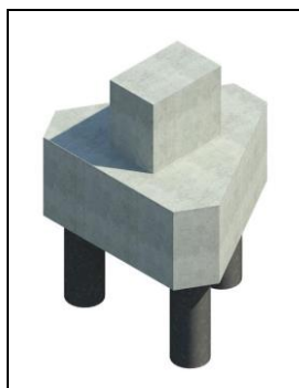
รูปที่ 4.9 แบบจำลองงานฐานรากที่มีรูปแบบแตกต่างจากแบบจำลองงานฐานรากที่มีอยู่ในระบบของซอฟต์แวร์
