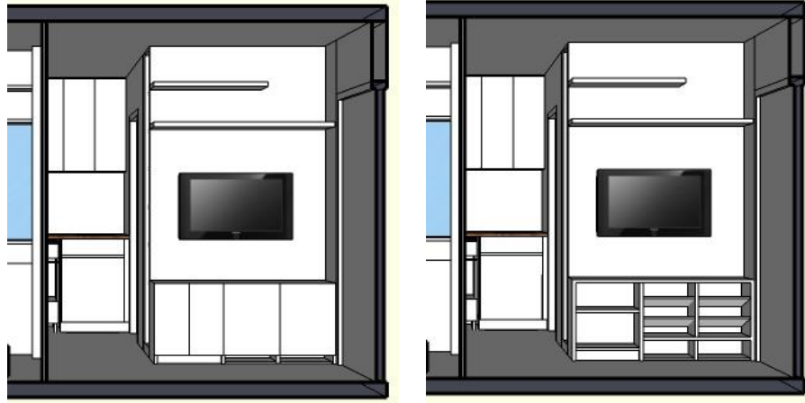
ภาพที่ 6.21 แสดงรูปด้านเครื่องเรือน ชุดที่2 (ชั้นวางTV + ตู้รองเท้า)
