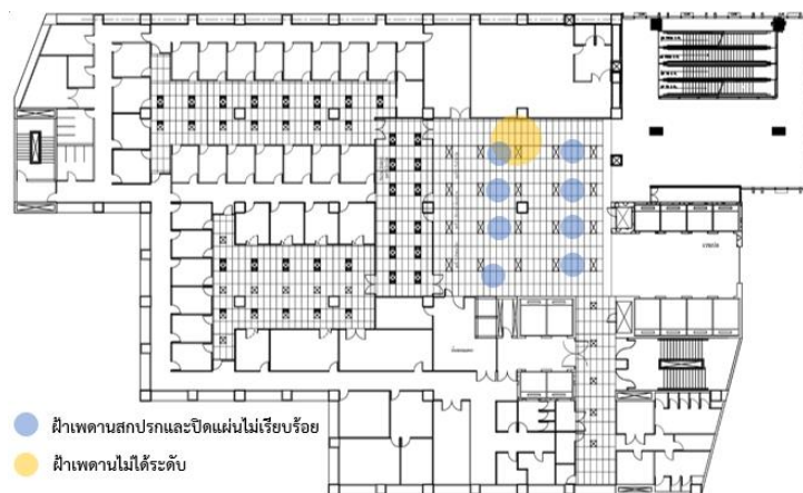
ภาพที่ 4.19 ตำแหน่งสภาพฝ้าเพดานของพื้นที่พักรอตรวจ
