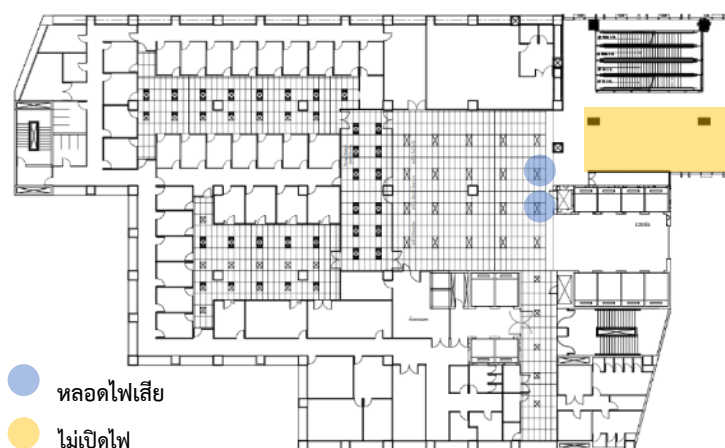
ภาพที่ 4.24 สภาพระบบแสงสว่างของพื้นที่พักรอตรวจ
