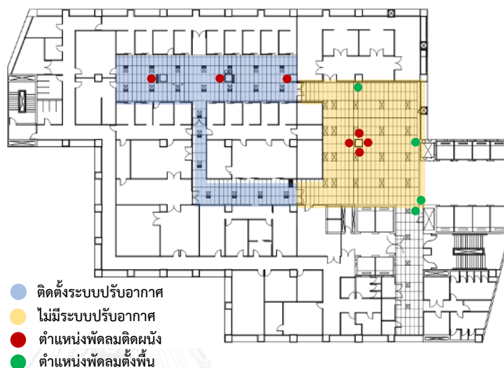
ภาพที่ 4.65 สภาพระบบระบายอากาศของพื้นที่พักรอตรวจ
