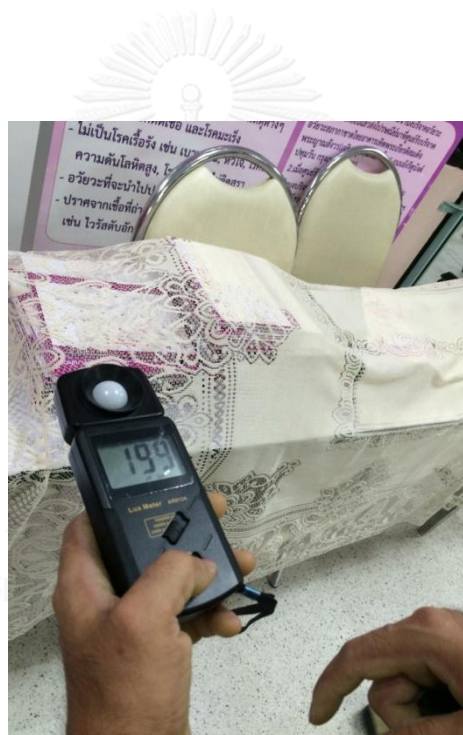
รูป ข. 4 การตรวจวัดค่าแสงสว่างของหลอดไฟ
