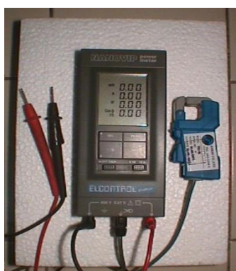
รูปที่ 3.2 มิเตอร์วัดกำลังไฟฟ้า
