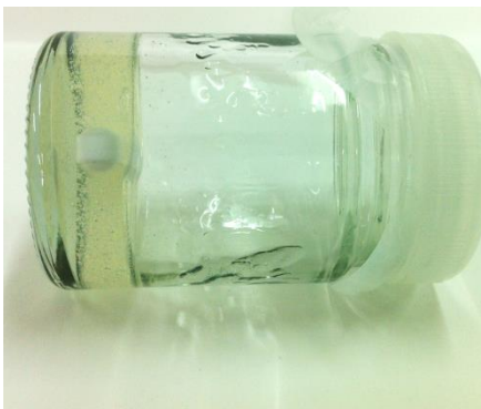
ภาพที่ 4.25 สารละลายตั้งต้นที่เตรียมจากสภาวะ 3.2 ซึ่งผ่านการบ่มที่อุณหภูมิ 80°C เป็นเวลา 60 นาที
