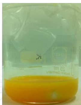
ภาพที่ 4.37 สารละลายตั้งต้น (สภาวะ 4.2 ตารางที่ 3.9) ที่ผ่านกระบวนการกระจายอนุภาคในอ่างอัลตราโซนิกสำหรับเตรียมเส้นใยนาโนเชิงประกอบ Pt/ \text{TiO}_2 -NP
