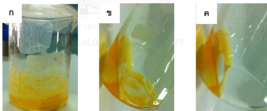
ภาพที่ 4.2 ภาพแสดงความสามารถในการละลายของ \text{H}_2\text{PtCl}_6 \cdot 6\text{H}_2\text{O} 30 mg/ml และ PVP 35 mg/ml ที่อัตราส่วนของน้ำต่อเอทานอลโดยปริมาตร (ก) 0.05 (ข) 0.1 และ (ค) 0.15
