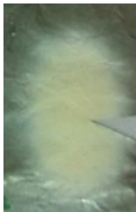
ภาพที่ 4.6 ลักษณะฟิล์มของเส้นใยนาโน PVP-Pt บนแผ่นอลูมิเนียมฟอยล์ซึ่งได้จากการปั่นเส้นใยด้วยไฟฟ้าสถิตที่ความต่างศักย์เท่ากับ 4.5 kV
