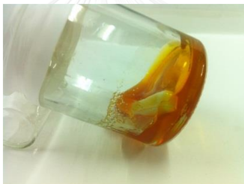
ภาพที่ 4.46 สารละลายตั้งต้นสภาวะ 5.2 หลังผ่านการบ่มที่ 70°C เป็นเวลา 30 นาที และเย็นตัวที่อุณหภูมิห้อง
