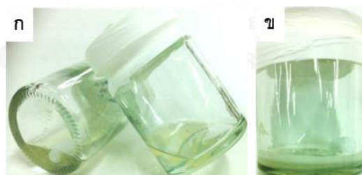
ภาพที่ 4.23 ลักษณะสารละลายตั้งต้นที่ผ่านการบ่มด้วยอุณหภูมิ 80°C เป็นเวลา 30 นาที เพื่อให้เกิดเจลในสารละลายโดยอัตราส่วนสารตั้งต้นที่เตรียมจาก (ก) สภาวะ 3.1 และ สภาวะ 3.2 และ (ข) สภาวะ 3.3
