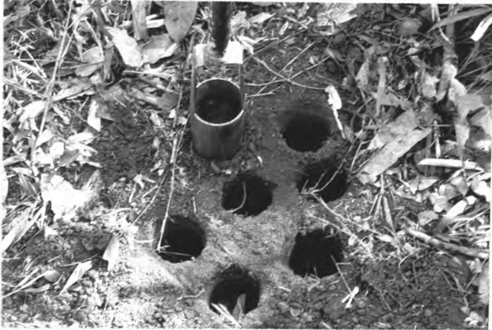
ภาพที่ 3.9 การเก็บดินด้วย soil core เพื่อวิเคราะห์ปริมาณน้ำในดิน
