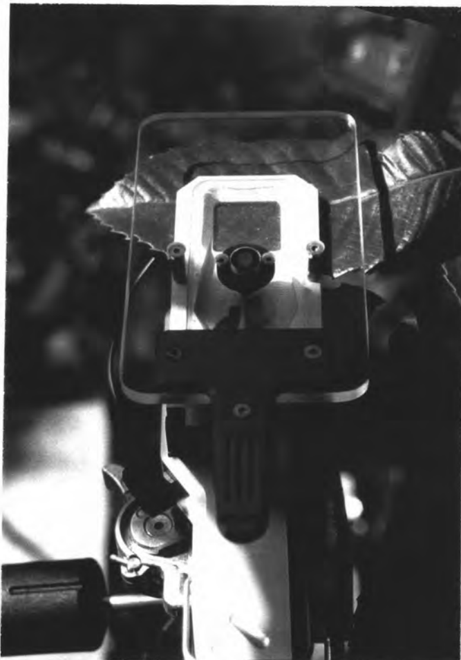
ภาพที่ 3.8 แสดง chamber ชนิด broad chamber ของเครื่อง LCA4 ในการวัดอัตราการสังเคราะห์ด้วยแสง
