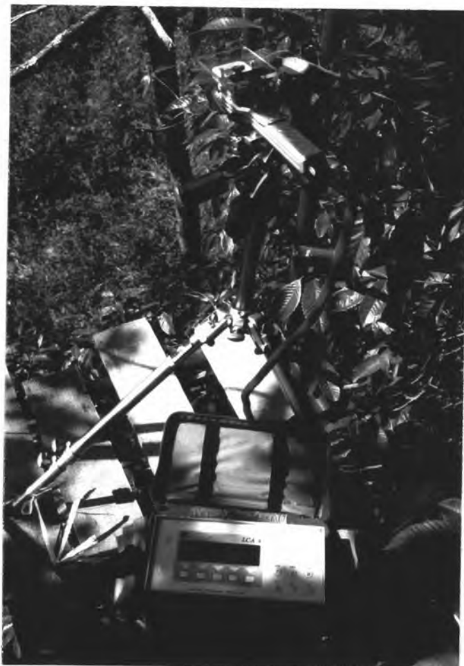
ภาพที่ 3.7 การตั้งเครื่อง portable photosynthetic system (LCA4) เพื่อวัดการสังเคราะห์ด้วยแสง
