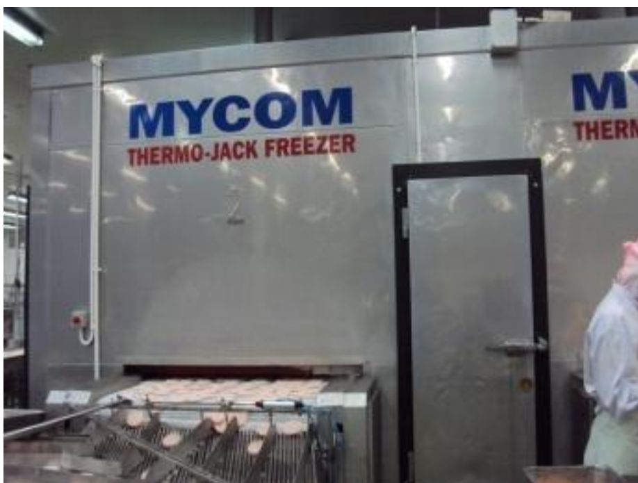
รูปที่ 4-13 เครื่องแช่แข็ง THERMO JACK FREEZER รุ่น MMF-1218TJ-AX2-BELT ของ MYCOM กำลังการผลิต 1400 กิโลกรัมต่อชั่วโมง
