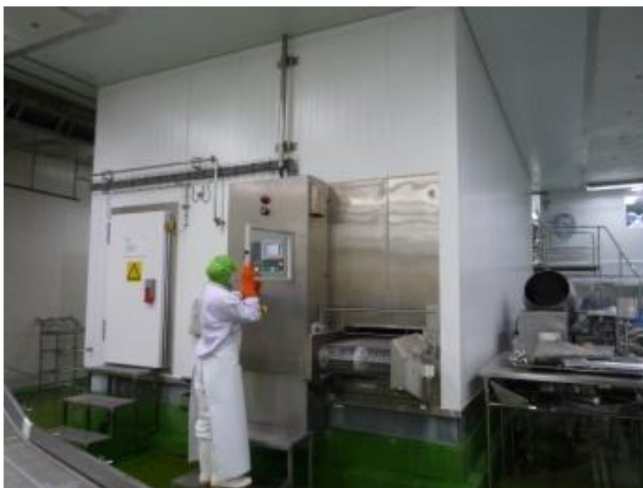
รูปที่ 4-12 เครื่องแช่แข็ง Spiral Freezer รุ่น GC600-08-24-14NS ของ JBT FOOD TECH กำลังการผลิต 2300 กิโลกรัมต่อชั่วโมง
