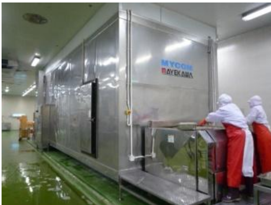
รูปที่ 4-11 เครื่องแช่แข็งเป็นระบบสายพานรุ่น MSF-15XX-TJAX ของ MYCOM กำลังการผลิต 300 กิโลกรัมต่อชั่วโมง
