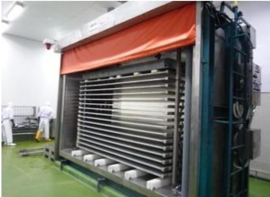
รูปที่ 4-9 ตู้แช่แข็งแบบเฟลทนอนน มีเฟลท 16 ชั้น อุณหภูมิใช้งาน -25 องศาเซลเซียส
