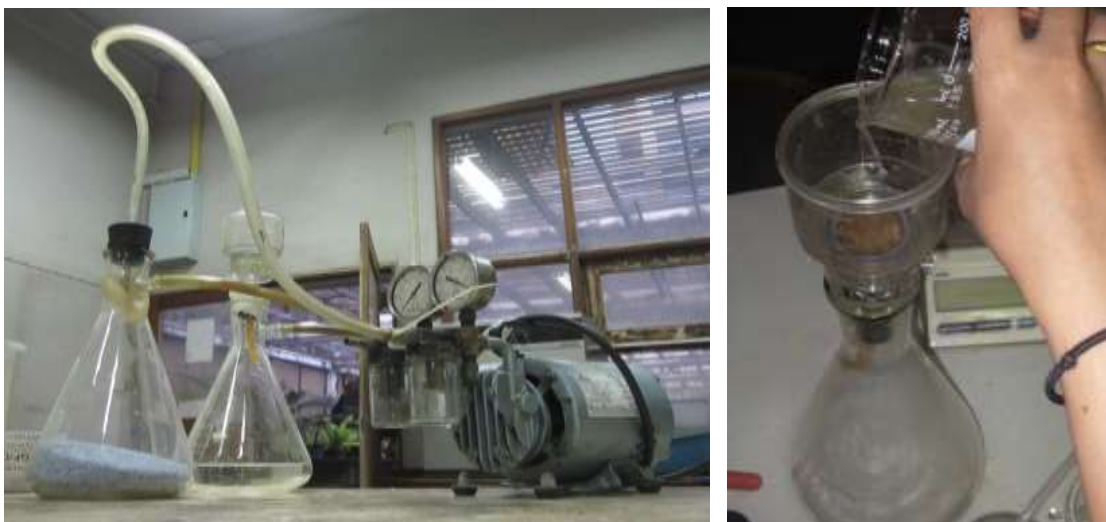
ภาพที่ 3.8 ชุดกรองสูญญากาศบูชเนอร์และเครื่องดูดสูญญากาศ (0211-103A-G230CX, Gast Manufacturing Inc., Michigan, USA) สำหรับกรองตะกอนแขวนลอยจากตัวอย่างน้ำ
