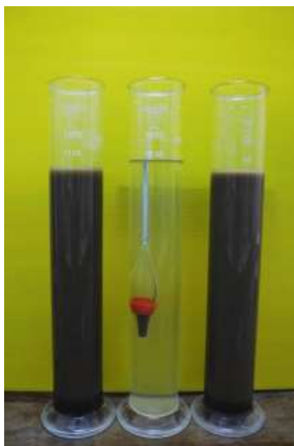
ภาพที่ 3.12 การวิเคราะห์เนื้อดินโดยวิธี Hydrometer method
