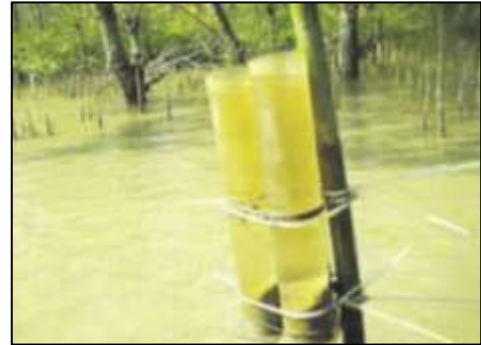
(ข) เครื่องดักตะกอน (sediment trap) (พิพัฒน์ พัฒนผลไพบุลย์, ศศิธร พ่วงปาน และสมภาพ รุ่งสุภา, 2551)
