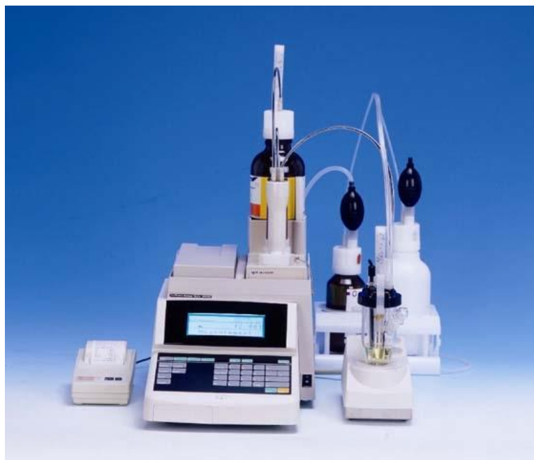
รูปที่ 3.5 เครื่องทดสอบหาความชื้น Karl Fisher Moisture Titrator รุ่น MKS-510 ที่มา www.oscscientific.us
