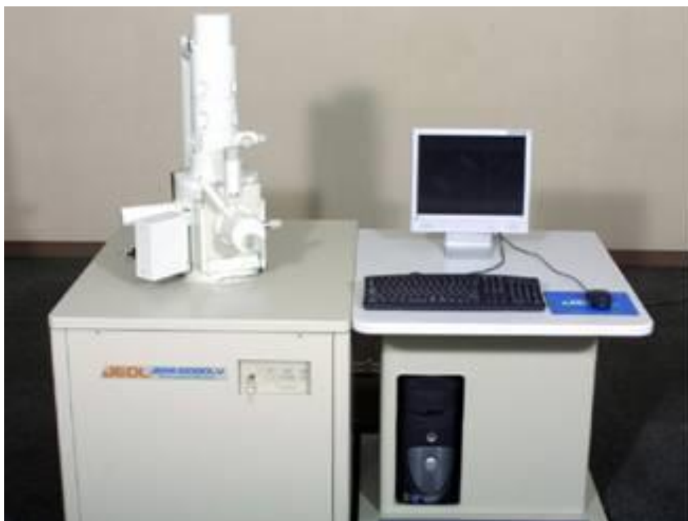
รูปที่ 3.4 เครื่องจุลทรรศน์อิเล็กตรอนแบบส่องกราด (SEM) รุ่น JEOL JSM 6060
