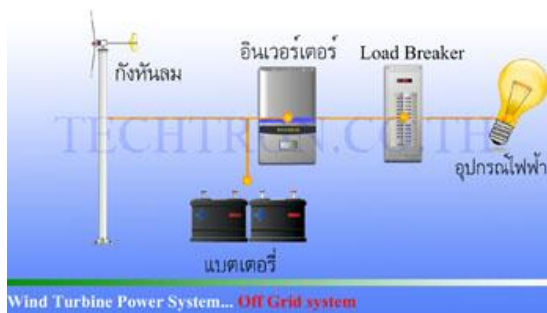
รูปที่ 2.1 การนำพลังงานไฟฟ้าจากระบบกังหันลมไปใช้กับเครื่องใช้ไฟฟ้า
