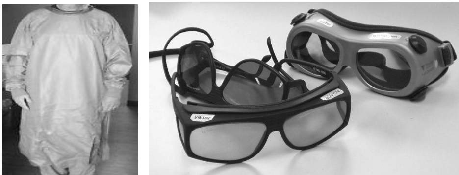
รูปที่ 2.9 แสดงชุดและแว่นป้องกันอันตรายจากเลเซอร์ (ที่มา: https://en.wikipedia.org/wiki/EN_207 )
