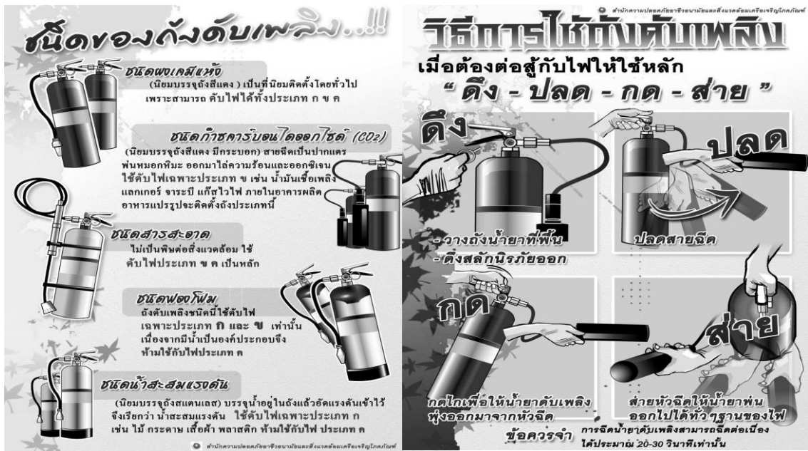
รูปที่ 2.8 แสดงชนิดและวิธีการใช้ถังดับเพลิง (ที่มา: www.buayaicity.go.th/fireman/index.php/2014-08-20-14-39-04 )
