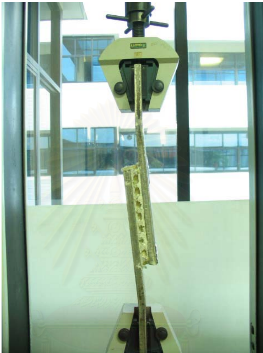
รูปที่ 4.20 ลักษณะการทดสอบความทนแรงเหวี่ยงของโครงสร้างรังผึ้ง
