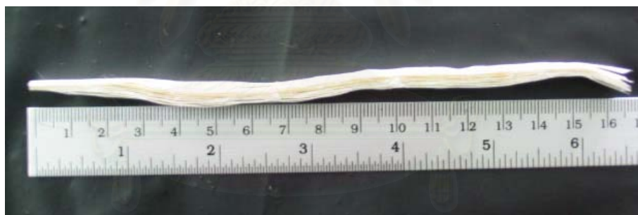
รูปที่ 5.5 ภาพขอบด้านบนของโครงสร้างรังผึ้งก่อนดึงขยาย
