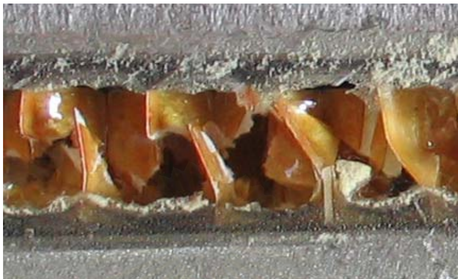
รูปที่ 5.17 โครงสร้างรังผึ้งหลังจากทดสอบความทนแรงเหวี่ยง (ด้านกว้าง)
