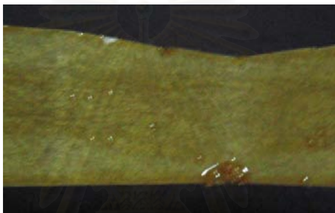
รูปที่ 4.13 ลักษณะผิวของโนเม็กซ์ที่เคลือบฟีนอลิเรซินที่มีความเข้มข้น 33.7% (ภาพด้านบน)
