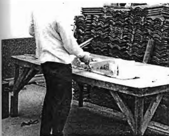
ภาพที่ 68 การทำแม่พิมพ์ยางของปูนปั้นประดับตกแต่งซุ้มกรอบหน้าต่าง
