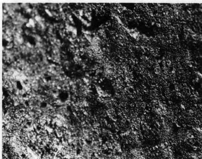
รูปที่ ข.5 สัณฐานวิทยาที่กำลังขยายของเส้นสัวิตถุ 4 เท่า ของพอลิเมอร์ผสมสัดส่วน พेट : แป้งมันสำปะหลัง ; 70 : 30 โดยในส่วนของผงพेटได้ผ่านการดัดแปรด้วยสารช่วยผสมความ เข้มข้น 10 g/100 g PET
