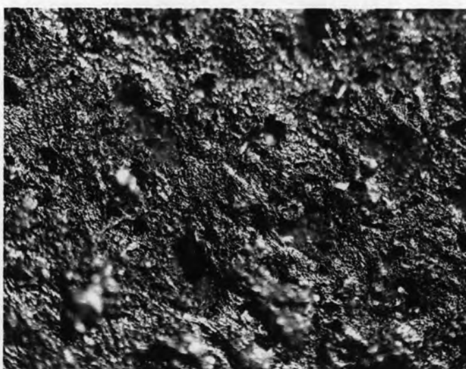
รูปที่ ข.5 สัณฐานวิทยาที่กำลังขยายของเส้นสัวิตถุ 4 เท่า ของพอลิเมอร์ผสมสัดส่วน พेट : แป้งมันสำปะหลัง ; 70 : 30 โดยในส่วนของผงพेटได้ผ่านการดัดแปรด้วยสารช่วยผสมความ เข้มข้น 10 g/100 g PET
