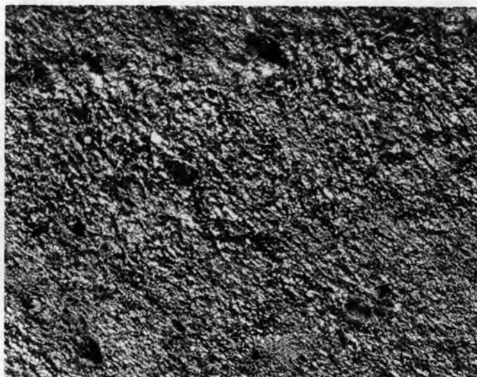
รูปที่ ข.13 สัณฐานวิทยาที่กำลังขยายของเลนส์วัตถุ 4 เท่า ของพอลิเมอร์ผสมสัดส่วน เพต : แป้งมันสำปะหลัง ; 90 : 10 โดยในส่วนของผงเพตได้ผ่านการดัดแปรด้วยสารช่วยผสมความ เข้มข้น 30 g/100 g PET
