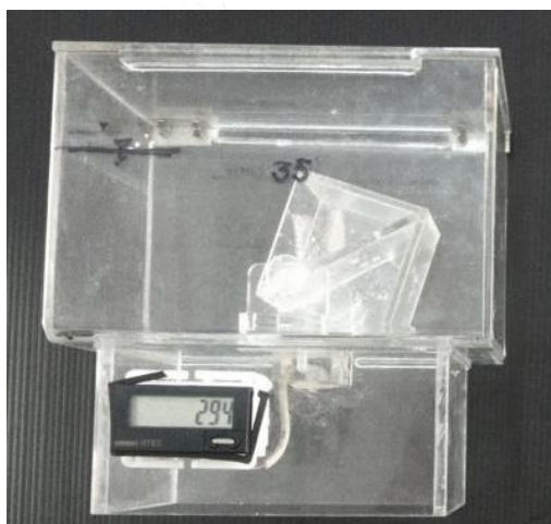
รูปที่ 3. 4 เครื่องวัดปริมาตรก๊าซตามแบบของศักดิ์ชัย ที่มา : ศักดิ์ชัย โอภาสวัตชัย (2526)
