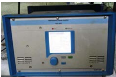
รูปที่ 3.6 ชาร์จแอมป์ไฟเออร์สำหรับขยายสัญญาณแรงตัด
