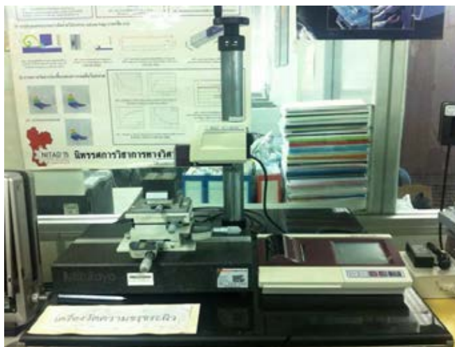
รูปที่ 3.8 เครื่องวัดความขรุขระผิวชิ้นงาน
