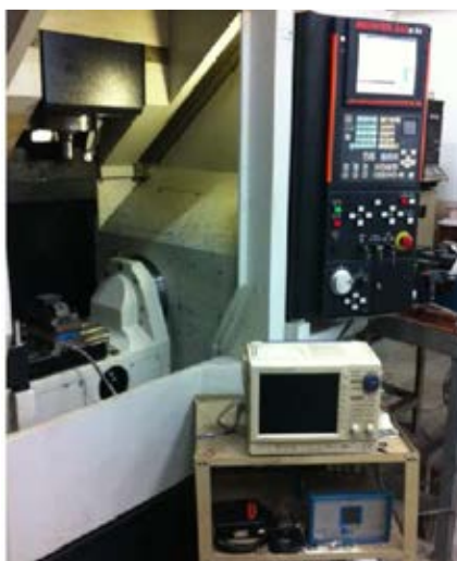
รูปที่ 3.11 การเชื่อมต่อสายไดนาโมมิเตอร์กับเครื่องขยายสัญญาณและเครื่องออสซิลโลสโคป
