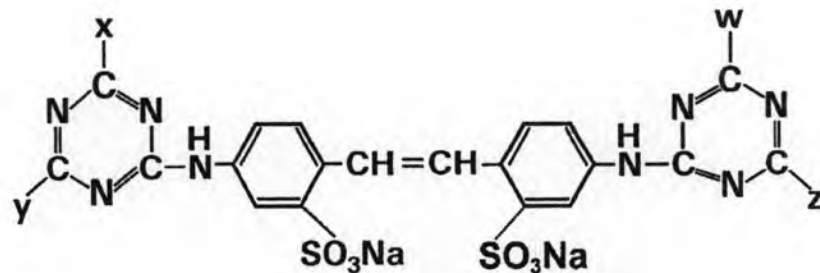
ภาพที่ 5 โครงสร้างทางเคมีของสารเพิ่มความขาวสว่าง
