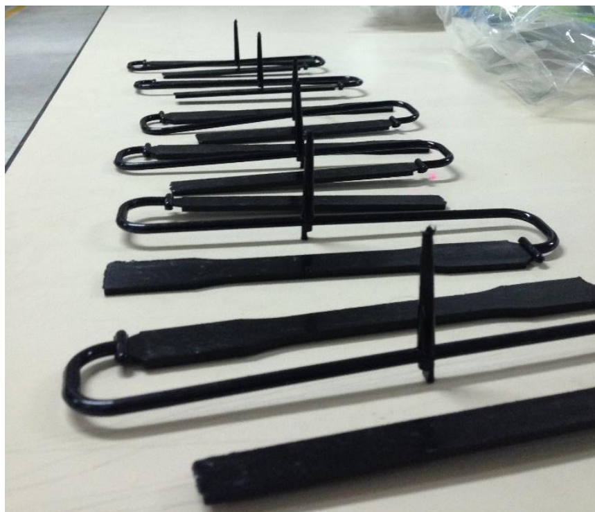
รูปที่ 22 การขึ้นรูปชิ้นงานสูตรส่วนผสมละ 30 ชั้น โดยใช้แม่พิมพ์คัมเบล
