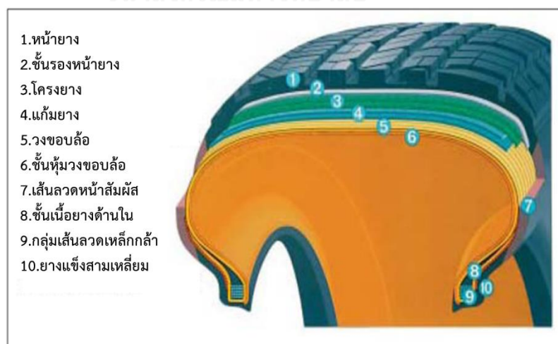
รูปที่ 10 ส่วนประกอบหลักของยางล้อรถยนต์ (Tire Component)
