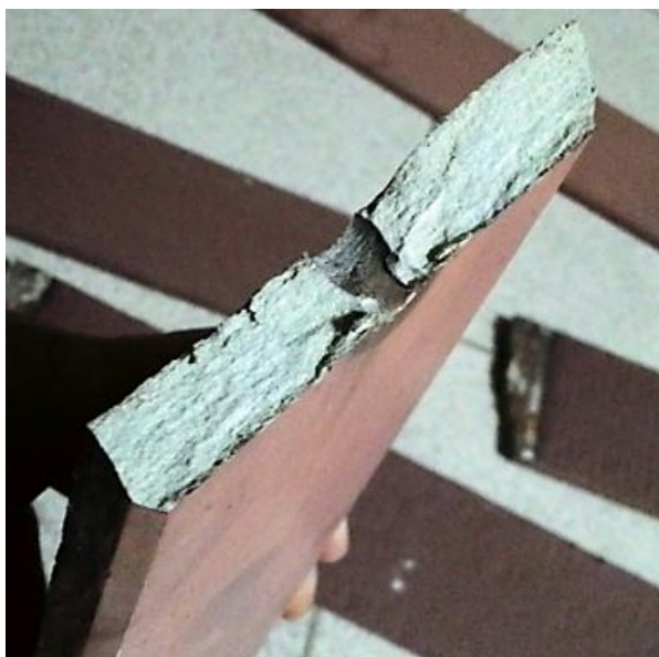
รูปที่ 35 ข้อจำกัดของไม้เทียม (ไม้อีเอ็ม) หลังติดตั้ง 1 ปี
