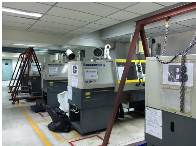
รูปที่ 19 เครื่องขึ้นรูปแบบฉีด (L/D > 60 cm) ขนาด 40 ตัน ยี่ห้อ Battenfeld BA 250 CDC
