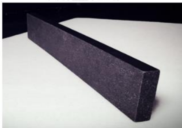
รูปที่ 49 ต้นแบบผลิตภัณฑ์ไม้คอมโพสิตจากยางล้อรถยนต์รีเคลม
