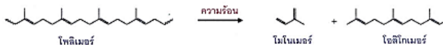
รูปที่ 15 การสลายตัวของพอลิเมอร์เมื่อได้รับความร้อน
