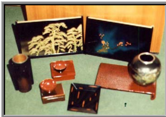
รูปที่ 4 ภาพของที่เคลือบผิวด้วยวาณิชจาก CNSL
