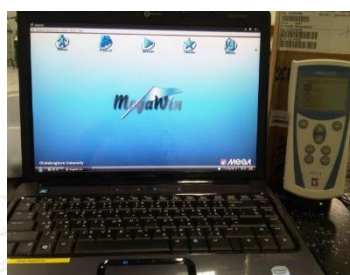
รูปที่ 4 เครื่อง Surface electromyography เครื่องหมายการค้า Megawin รุ่น ME6000 พร้อม Software version 3.0
