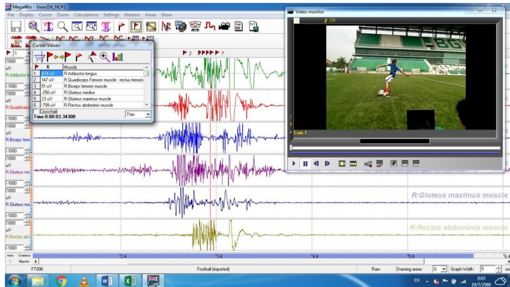
รูปที่ 14 แสดงข้อมูล Raw EMG ของคลื่นสัญญาณไฟฟ้ากล้ามเนื้อ ที่ได้จากโปรแกรม Megawin 6000 Version 3 และกำหนดจุดเริ่มต้นและจุดสิ้นสุดในแต่ละช่วงของการเตะลูกฟุตบอล
