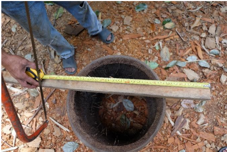
ภาพที่ 264 การวัดไม้ทำขาโพนให้ได้ความยาว 65 เซนติเมตร
