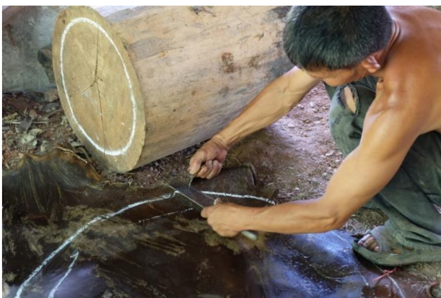
ภาพที่ 155 การใช้มีดตัดตามขอล็กที่ขีดไว้
