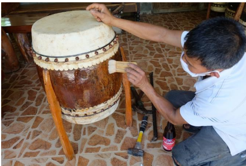
ภาพที่ 277 ทาหุ่นโพนด้วยน้ำยาเคลือบพื้นไม้
