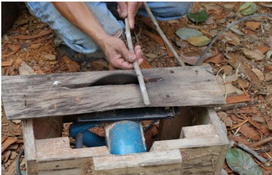
ภาพที่ 213 การใช้เครื่องเลื่อยวงเดือนตัดไม้ให้เป็นท่อนๆพร้อมทำลูกสัก
