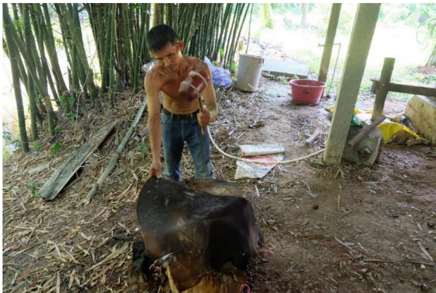
ภาพที่ 171 การใช้ค้อนไม้ตีหนังให้นุ่ม
