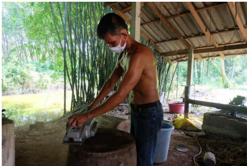
ภาพที่ 182 การไสเนื้อไม้ให้เรียบ
