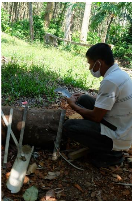
ภาพที่ 294 การเหลาแต่งลิ่ม
