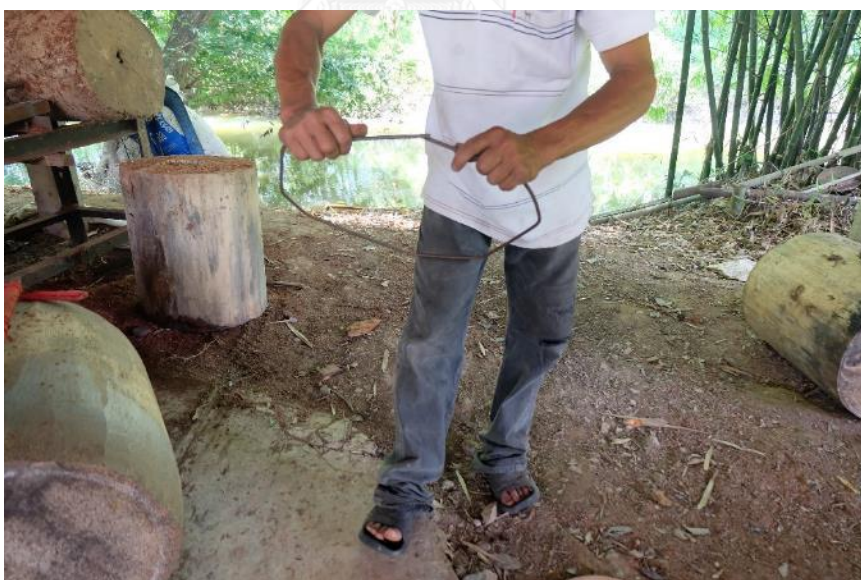
ภาพที่ 256 การตัดเหล็กเป็นวงกลม ให้ปลายทั้งสองข้างชนกัน
