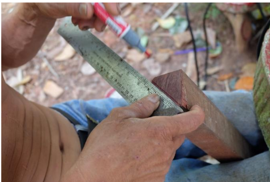
ภาพที่ 282 การใช้ปากกาเคมีขีดเป็นกากบาทให้เป็นเส้นจุดตัดทั้งสองด้าน
