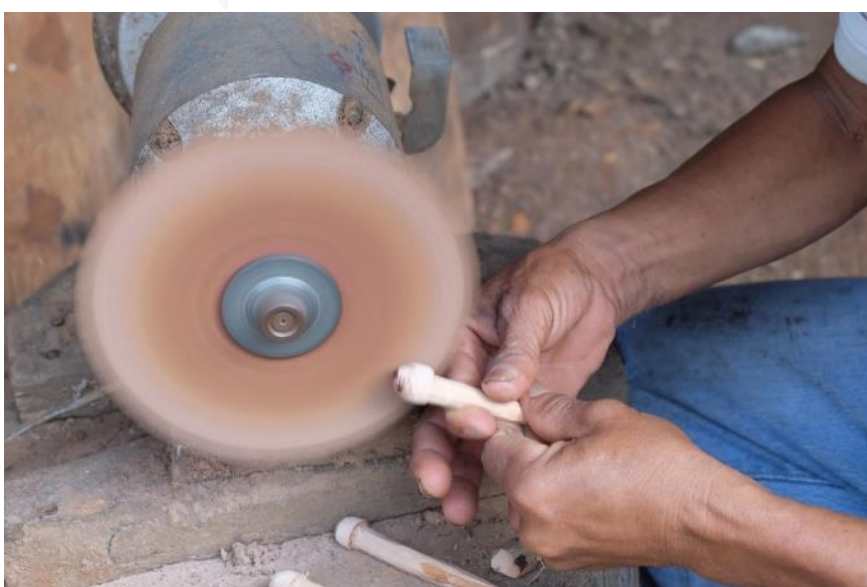
ภาพที่ 219 การใช้เครื่องขัดกระดาษทรายแบบแป้นหมุนขัดหัวลูกสั๊ก
