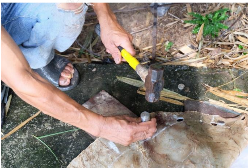
ภาพที่ 177 การเจาะรูด้วยตุ้ตตุ้
