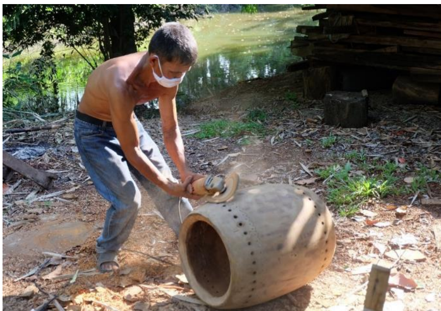
ภาพที่ 193 เมื่อเจาะรูเรียบร้อยแล้ว ให้ขีดด้วยเครื่องเจียร
