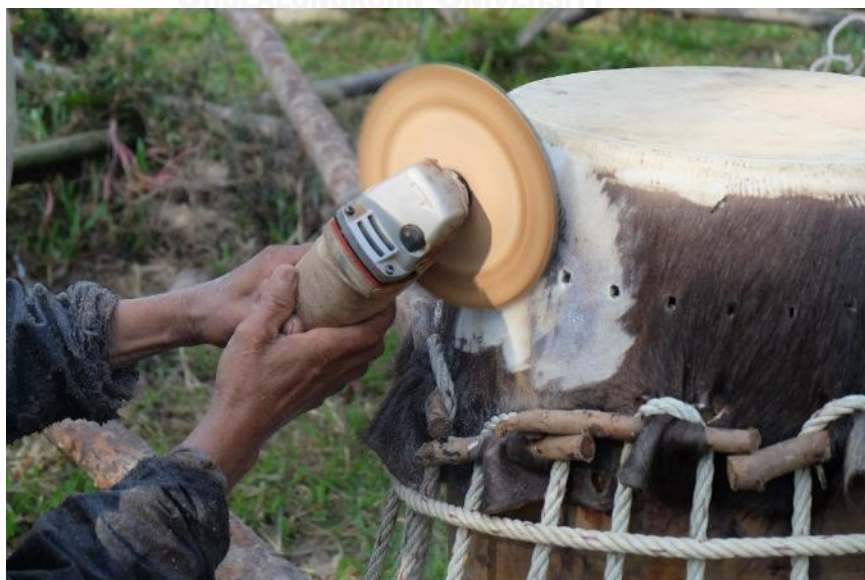
ภาพที่ 236 การขัดขนด้วยเครื่องเจียรกระดาษทราย
