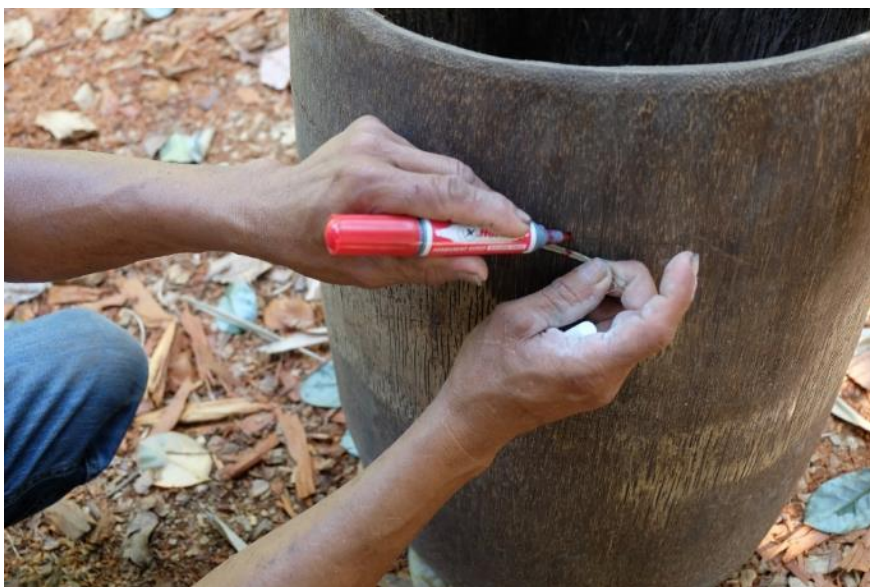
ภาพที่ 190 การจุดตำแหน่งเพื่อเจาะรูใส่ลูกสีก
