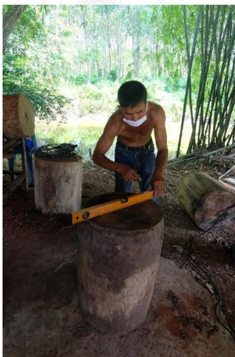
ภาพที่ 183 วัดหุ่นด้วยเครื่องวัดระดับน้ำแม่เหล็ก
