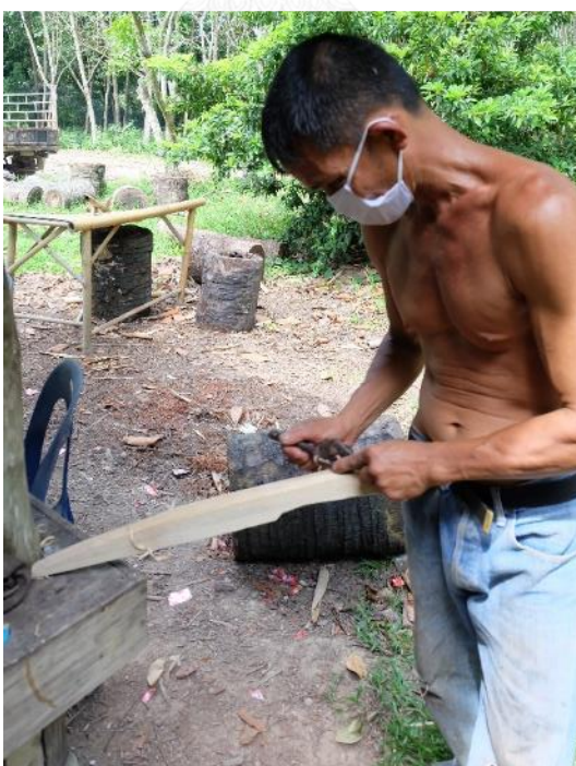
ภาพที่ 269 การใช้กบมือเหลาไม้ เพื่อลบเหลี่ยมมุมของขาโพน
