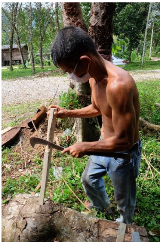
ภาพที่ 268 การใช้มีดพรั้าถากให้เป็นส่วนเว้าพอประมาณ เพื่อรับกับหุ่นโพน
