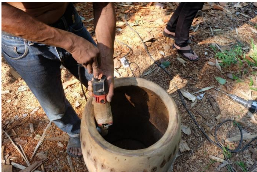
ภาพที่ 195 การใช้กระตาดทรายเกร็ดขัดขอบขัน
