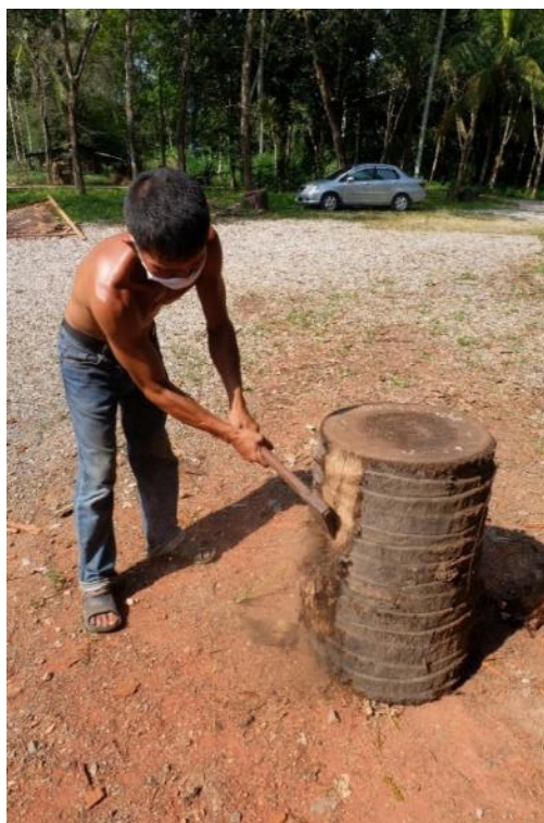
ภาพที่ 180 การใช้ขวานถากเนื้อไม้ส่วนนอกออกเล็กน้อย
