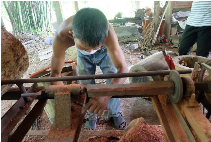
ภาพที่ 286 การไสไม้เพื่อเตรียมกลึง
