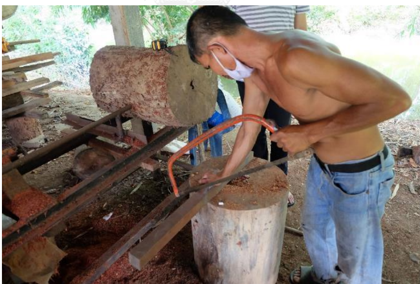
ภาพที่ 281 การเลื่อยไม้ตีโปน
