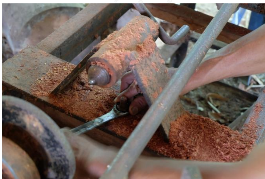
ภาพที่ 285 การใช้ประแจขันเลื่อยให้ได้ตามขนาดของไม้ที่ต้องการกลึง
