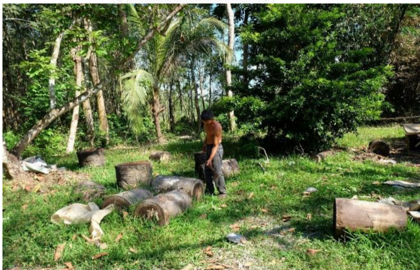
ภาพที่ 179 การตัดไม้ไว้เป็นท่อนๆ เพื่อเตรียมในการทำหุ่นโพน ช่างเตรียมไม้ โดยนำท่อนไม้มาทั้งต้น แล้วตัดส่วนล่างของไม้ทิ้งไป 2 เมตร แล้วจึงเริ่มตัด เป็นท่อนสำหรับทำโพน หลังจากนั้นจึงใช้ขวานถากเปลือกไม้ออกจนเหลือเฉพาะเนื้อไม้
