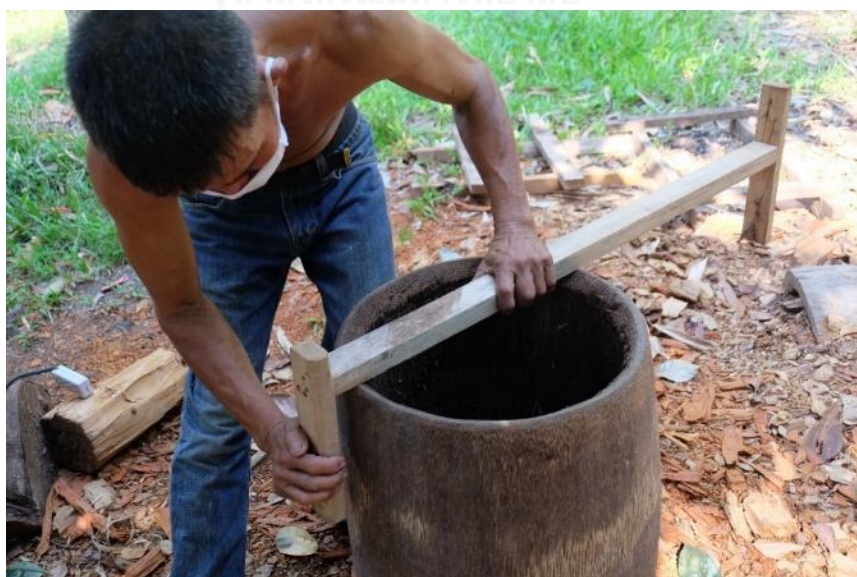
ภาพที่ 189 การขีดเส้นโดยใช้ที่วัดเส้นตรงรอบนอก
