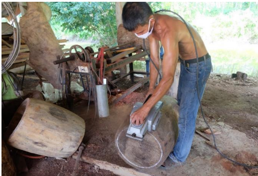
ภาพที่ 186 การใช้กบไฟฟ้าไสเนื้อไม้
