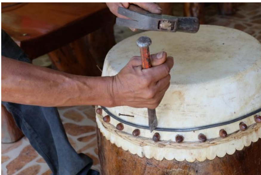
ภาพที่ 261 การใช้ส่วปากแบนตอกเหล็กลงไปให้ติดกับลูกสัก
