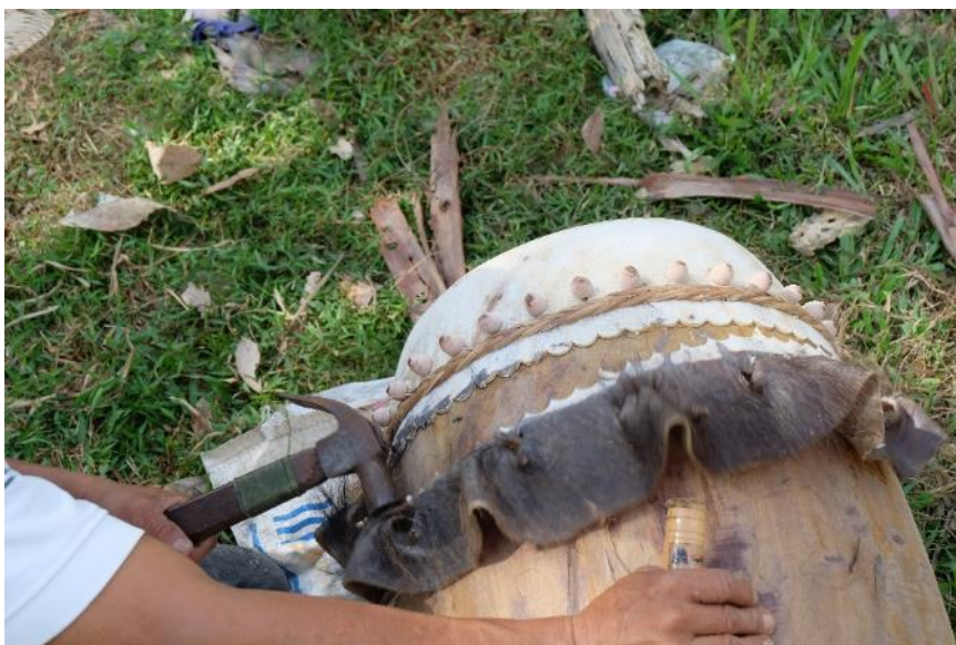
ภาพที่ 251 การใช้ค้อนตอกหนังออก
