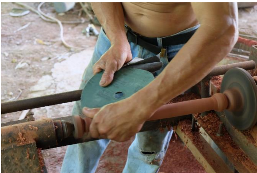
ภาพที่ 290 การขัดไม้โพนด้วยกระดาษทราย
