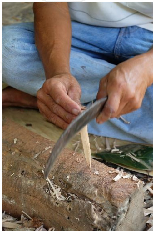
ภาพที่ 217 การเหลาปลายลูกสัก
