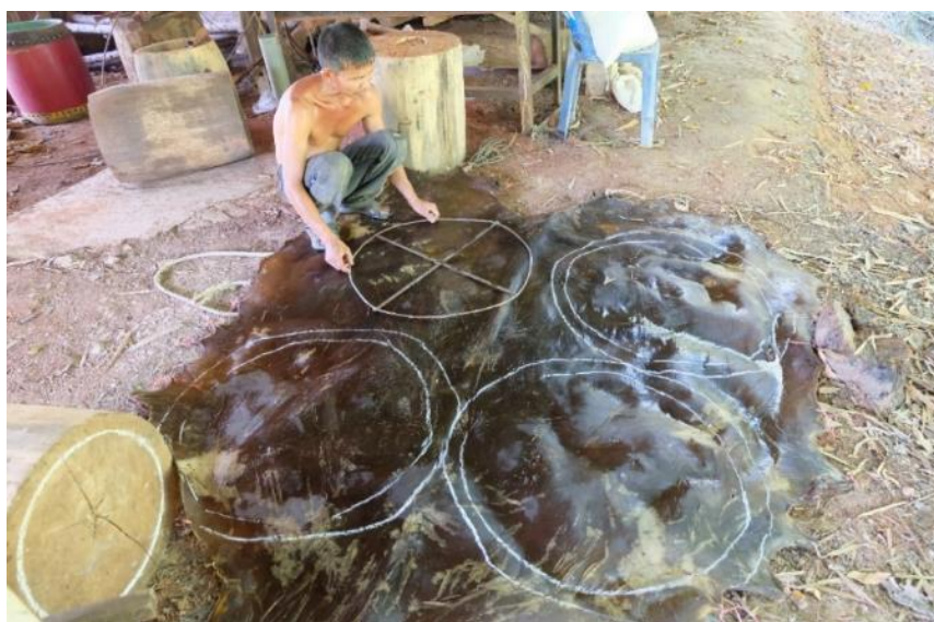
ภาพที่ 154 การใช้ที่วัดรอบนอกวางแล้วขีดกับขอล็กเขียนกระดาศ
