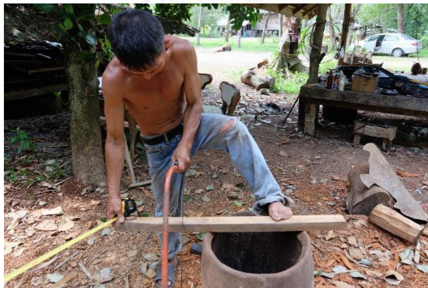
ภาพที่ 265 การเลื่อยตัดไม้ที่เหลือออก
