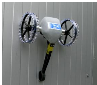
รูปที่ 2.3 หุ่นยนต์ MINOAS ที่ติดตั้งแม่เหล็กถาวรขนาดเล็กจำนวนมากที่ขอบล้อ [4]
