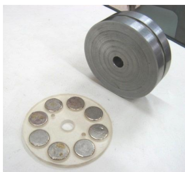
รูปที่ 3.8 ล้อแม่เหล็กที่ประกอบด้วยแม่เหล็กรูปทรงกระบอกจำนวนหลายชิ้นและแผ่นเหล็กตัน
