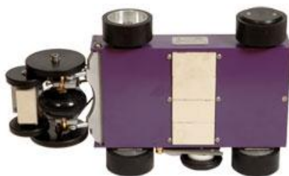
รูปที่ 2.2 หุ่นยนต์ใต้ผนัง Scorpion B-scan ที่ติดตั้งแม่เหล็กถาวรที่ด้านใต้ลำตัว [13]
