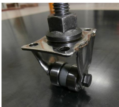
รูปที่ 3.10 ล้อแม่เหล็กที่ประกอบด้วยแม่เหล็กถาวรแรงสูงรูวงแหวนหนึ่งชิ้นและตลับลูกปืน
