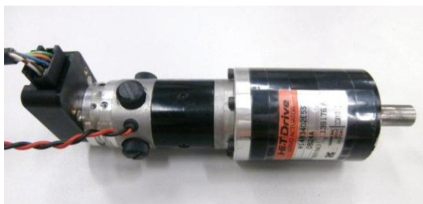
รูปที่ ผ.1 อุปกรณ์ในส่วนขับเคลื่อนล้อแม่เหล็กด้านหน้า
