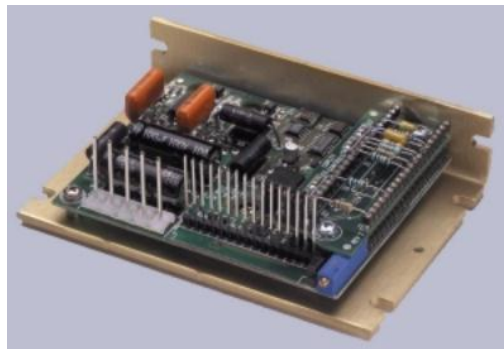
รูปที่ ผ.5 อุปกรณ์ขยายสัญญาณ Copley รุ่น 4122P [36]
