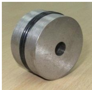
รูปที่ 3.6 ล้อแม่เหล็กที่ประกอบด้วยแม่เหล็กรูปวงแหวนขนาดใหญ่หนึ่งชิ้นและแผ่นเหล็กตัน
