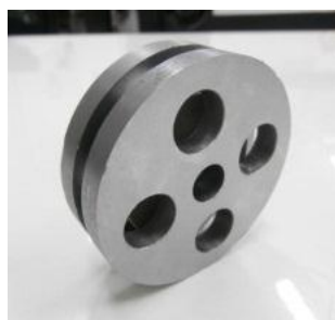
รูปที่ 3.7 ล้อแม่เหล็กที่ประกอบด้วยแม่เหล็กรูปวงแหวนขนาดใหญ่หนึ่งชิ้นและแผ่นเหล็กที่เจาะรูในแนวรัศมีของล้อ
