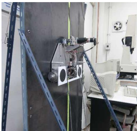
รูปที่ 6.7 การยึดเกาะและการเคลื่อนที่ของหุ่นยนต์บนผนังเหล็กเอียง 270 องศา
