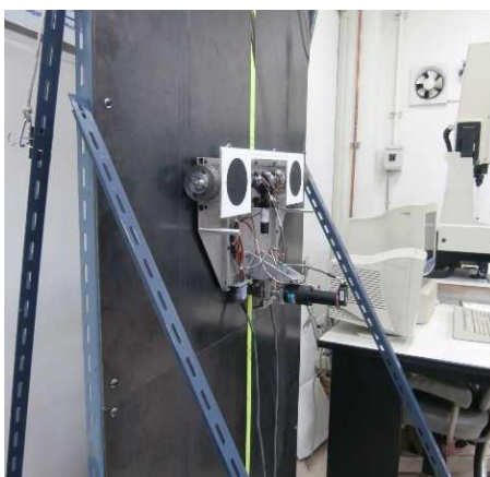
รูปที่ 6.3 การยึดเกาะและการเคลื่อนที่ของหุ่นยนต์บนผนังเหล็กเอียง 90 องศา
