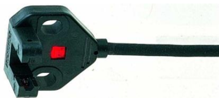
รูปที่ ผ.8 อุปกรณ์ตรวจวัดแสงขนาดเล็ก OMRON [40]
