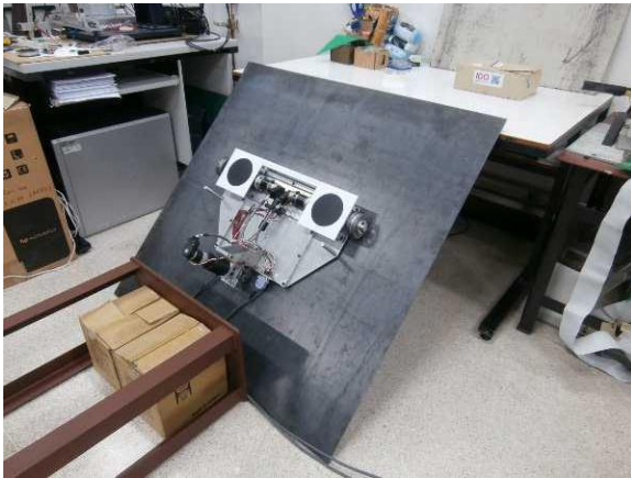
รูปที่ 6.4 การยึดเกาะและการเคลื่อนที่ของหุ่นยนต์บนผืนเหล็กเอียง 135 องศา
