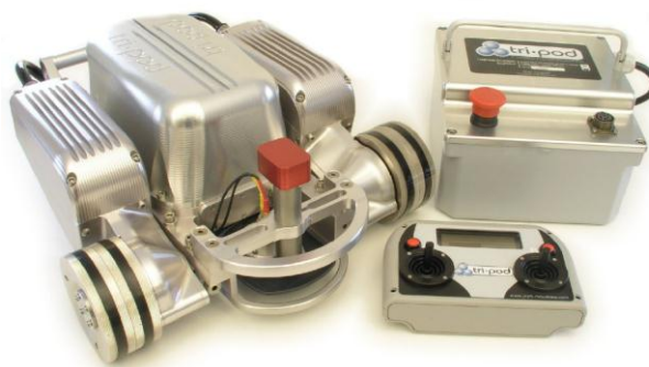
รูปที่ 2.7 หุ่นยนต์ TriPod ที่ใช้ล้อแม่เหล็ก [17]
