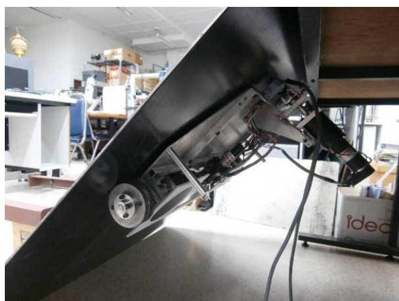
รูปที่ 6.8 การยึดเกาะและการเคลื่อนที่ของหุ่นยนต์บนผนังเหล็กเอียง 315 องศา
