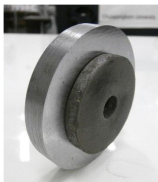
รูปที่ 3.5 การประกอบล้อแม่เหล็กจากแม่เหล็กถาวรแรงสูงรูปวงแหวนและแผ่นเหล็ก
