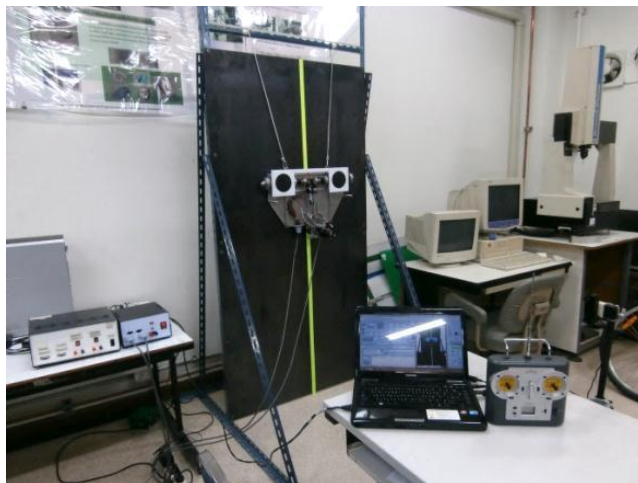
รูปที่ 6.9 การจัดชุดการทดสอบการเคลื่อนที่ของหุ่นยนต์บนผนังแนวตั้ง
