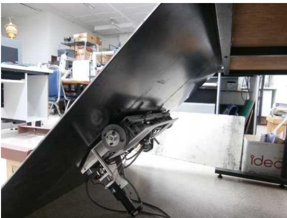
รูปที่ 6.2 การยึดเกาะและการเคลื่อนที่ของหุ่นยนต์บนผนังเหล็กเอียง 45 องศา
