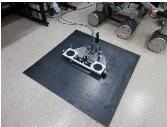
รูปที่ 6.5 การยึดเกาะและการเคลื่อนที่ของหุ่นยนต์บนผืนเหล็กเอียง 180 องศา
