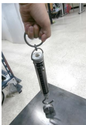
รูปที่ 3.4 การทดสอบแรงดึงดุดระหว่างล้อแม่เหล็กกับผนังเหล็ก
