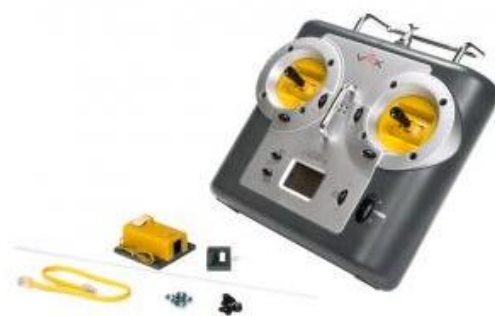
รูปที่ ผ.6 อุปกรณ์ส่งและรับสัญญาณวิทยุ VEX ความถี่ 75.970 เมกะเฮิรตซ์ [37]
