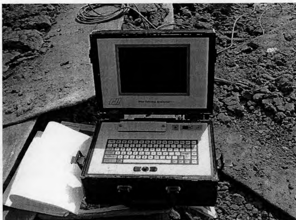
รูปที่ ก.10 เครื่อง PDA ที่ใช้ในการรับสัญญาณจากการทดสอบเสาเข็มเจาะ
