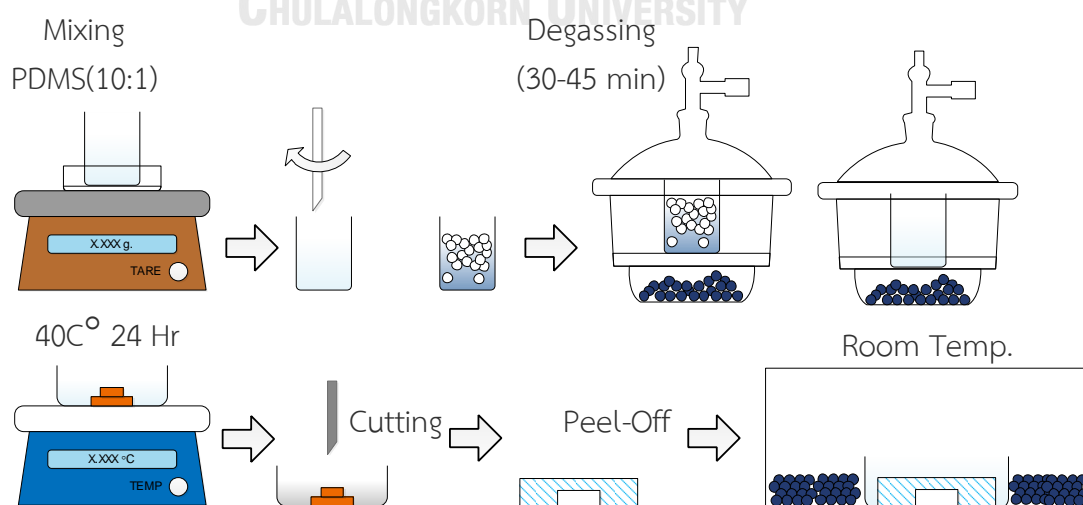
รูปที่ 3.5 กระบวนการผลิตชั้นควบคุมด้วยวิธีซอฟต์แวร์ลิโทกราฟี (Soft Lithography)
