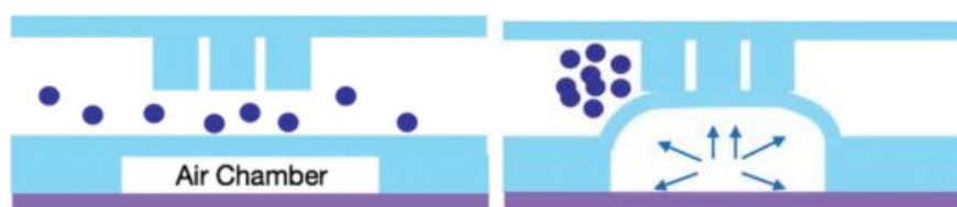
รูปที่ 2.17 ระบบดักจับและปลดปล่อยเซลล์ ตอนยังไม่ทำงาน (ภาพซ้าย) และตอนทำงาน (ภาพขวา) [32]
